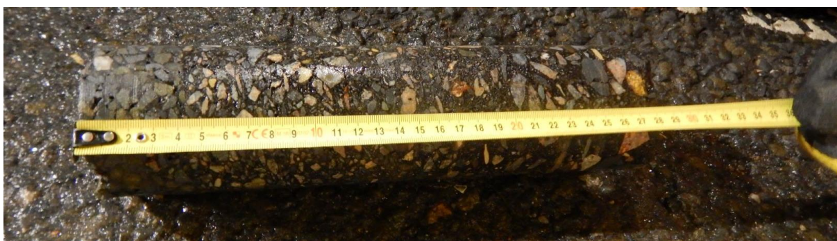
Obr. 11: Jádro z vývrtu V3 – silnice II/317 směr Borohrádek, 50 m za kruhovým objezdem
