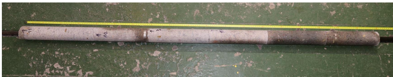
Obr. 5: Jádro z vývrtnu V1 – dřík opěry O1, příprava ke zkoušení
