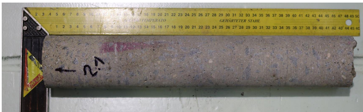
Obr. 14: Karbonatace betonu – dřík opěry O2
