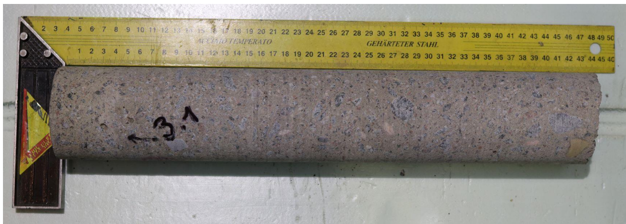
Obr. 7: Jádru z vývrtu S3 – úložný práh opěry O2, příprava ke zkoušení
