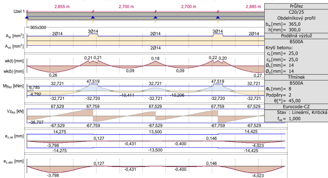
Vypočtená výztuž nosníku, 1 nosník (1-2), Lineární, (Auto) Kritická
