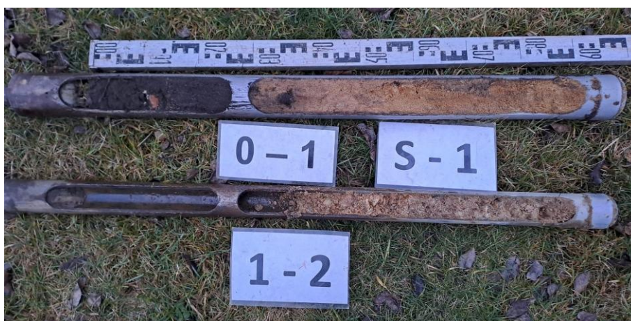
Obrázek 2 – Geologický profil sondy S-1
