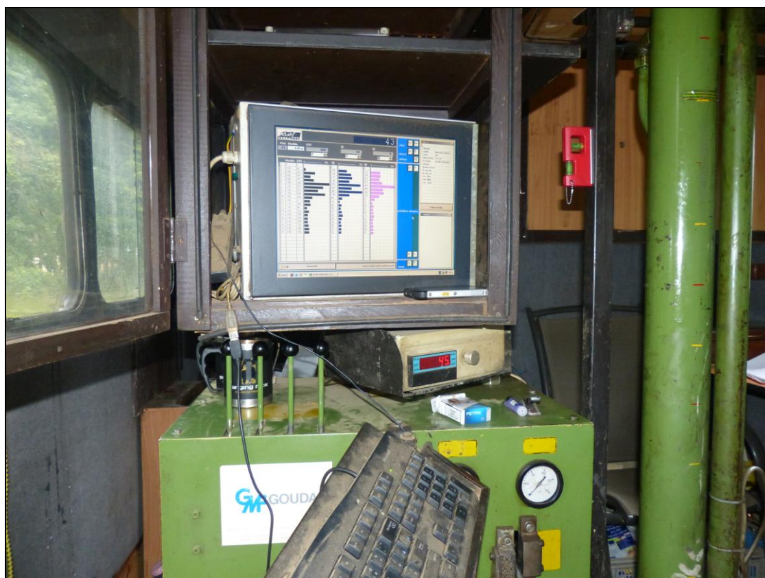
Foto č. 17-18 : Penetrační souprava Gouda Holland 200 kN - detail hydraulického zařízení pro zatlačování sondážního soutyči s mechanickým hrotem
