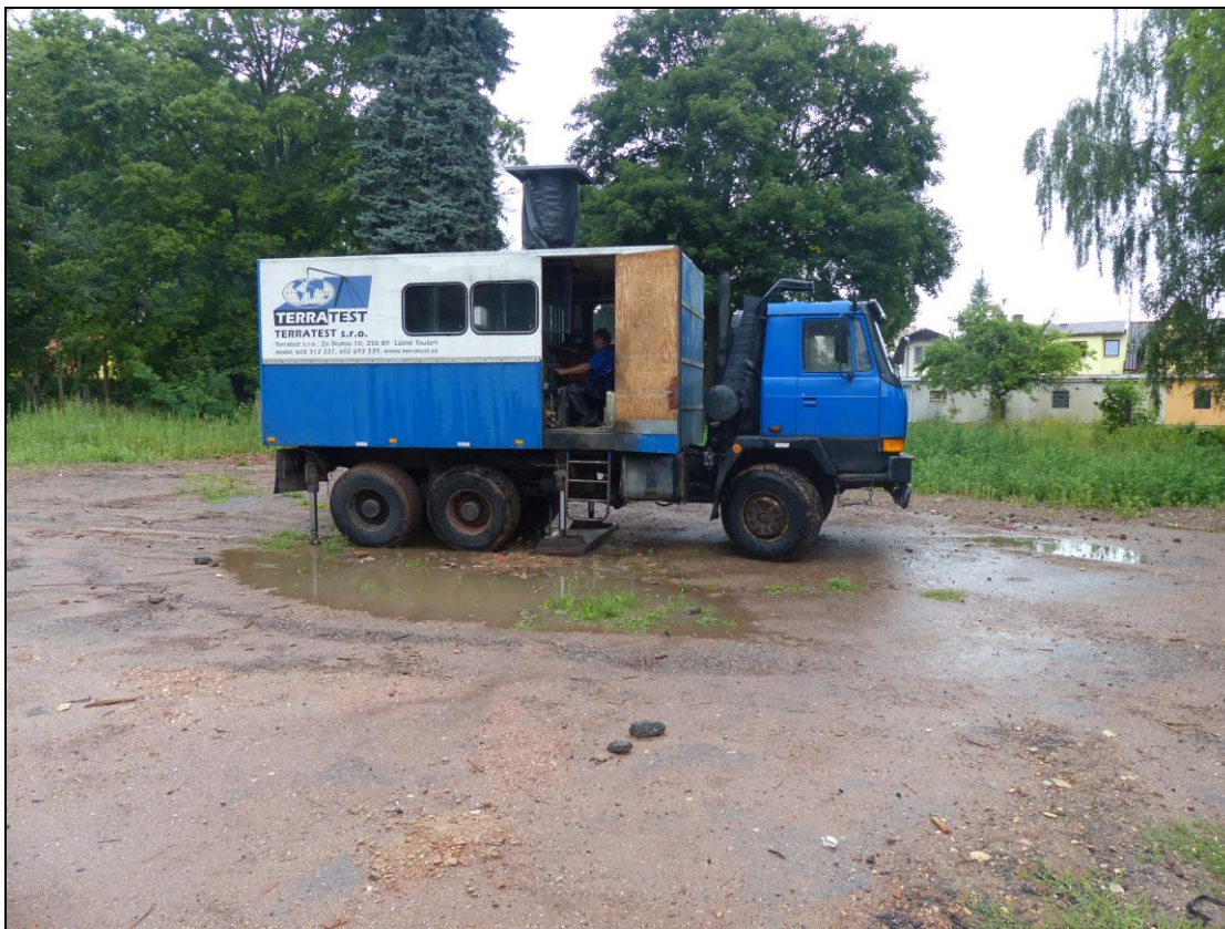
Foto č. 15 : Hydraulické zatlačování penetrační sondy SP-5 (hl. 20 m) těžkou statickou penetrační soupravou Gouda Holland 200 kN (foto 28.06. 2018)
