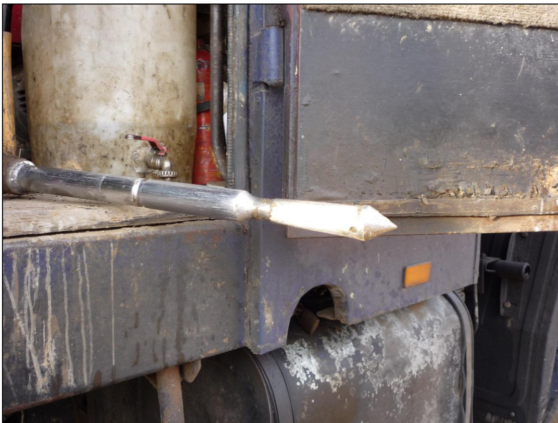
Foto č. 16 : Penetrační souprava Gouda Holland 200 kN - detail mechanického hrotu na úvodní části sondážního soutyčí
