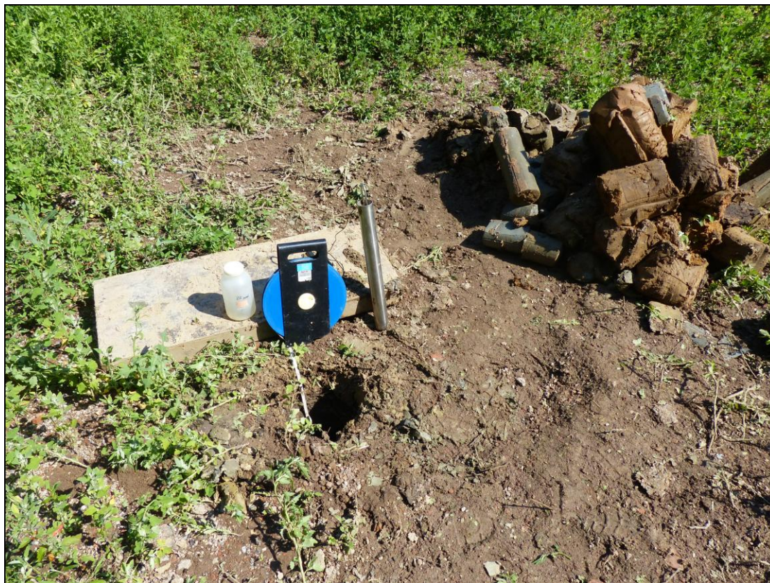
Foto č. 19 : Průzkumný vrt V-2 – zaměřování nivelety ustálené HPV certifikovaným elektrokontaktním hladinoměrem G30 (výrobce NPK Europe Mfg. s.r.o.) + odběr vzorku podzemní vody na ZCHR stavební (foto 28.06. 2018)
