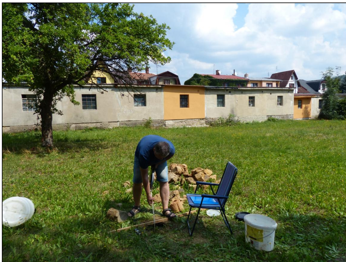
Foto č. 20 : Průzkumný vrt V-1 – provádění vsakovacího experimentu (foto 24.07. 2018)
