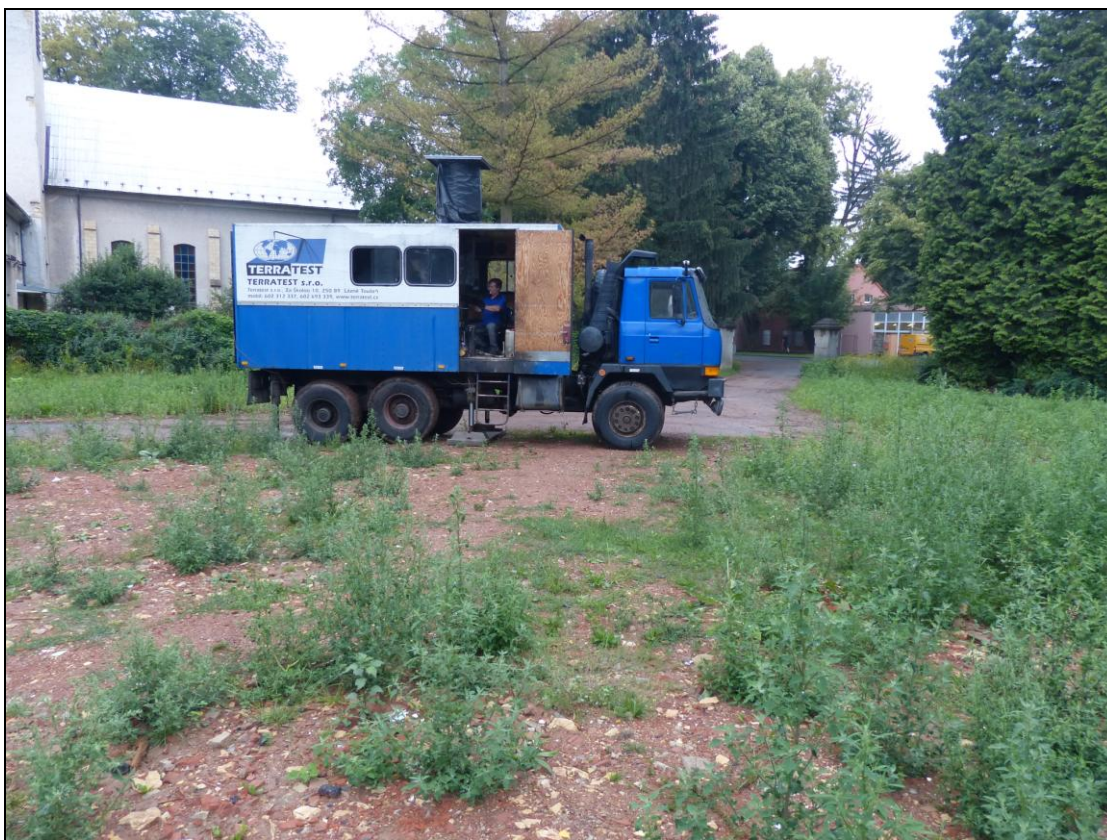
Foto č. 13-14 : Hydraulické zatlačování penetračních sond SP-2 (hl. 14 m) a SP-3 (hl. 14 m) těžkou statickou penetrační soupravou Gouda Holland 200 kN (foto 28.06. 2018)
