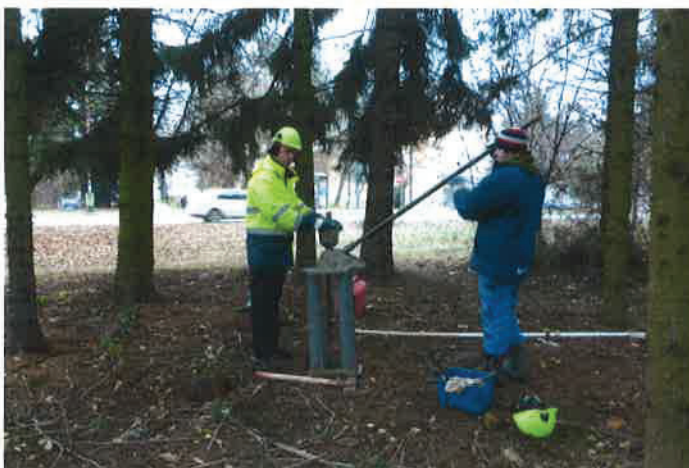
Foto č. 3: Hloubení průzkumné geologické sondy GS-2.
