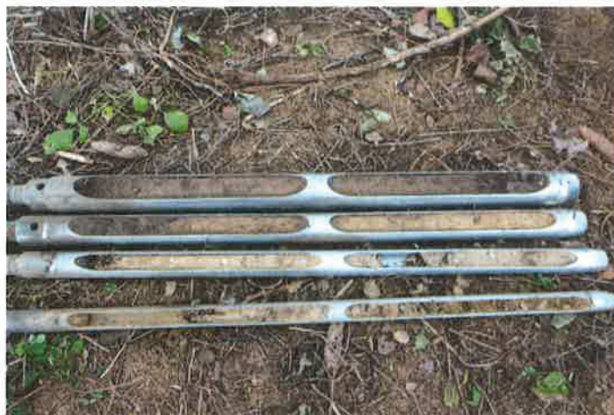
Foto č. 4: Výnos poloporušených vzorků zemin z geologické sondy GS-2.
