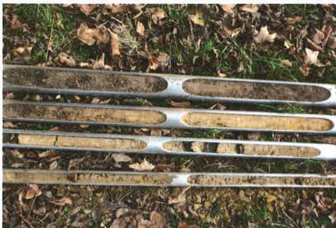
Foto č. 2: Výnos poloporušených vzorků zemin z geologické sondy GS-1.
