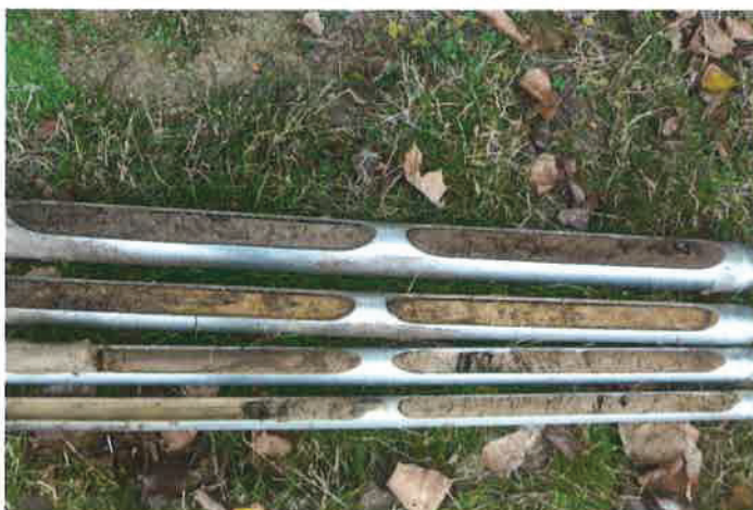
Foto č. 6: Výnos poloporušených vzorků zemin z geologické sondy GS-3.
