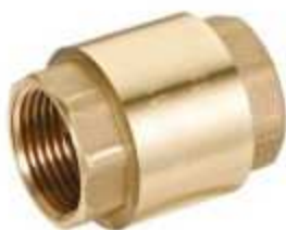
Zpětná klapka mosaz 2" ventily snesou teplotu 0°C - +95°C a tlak od 0 do 1, 6MPa
