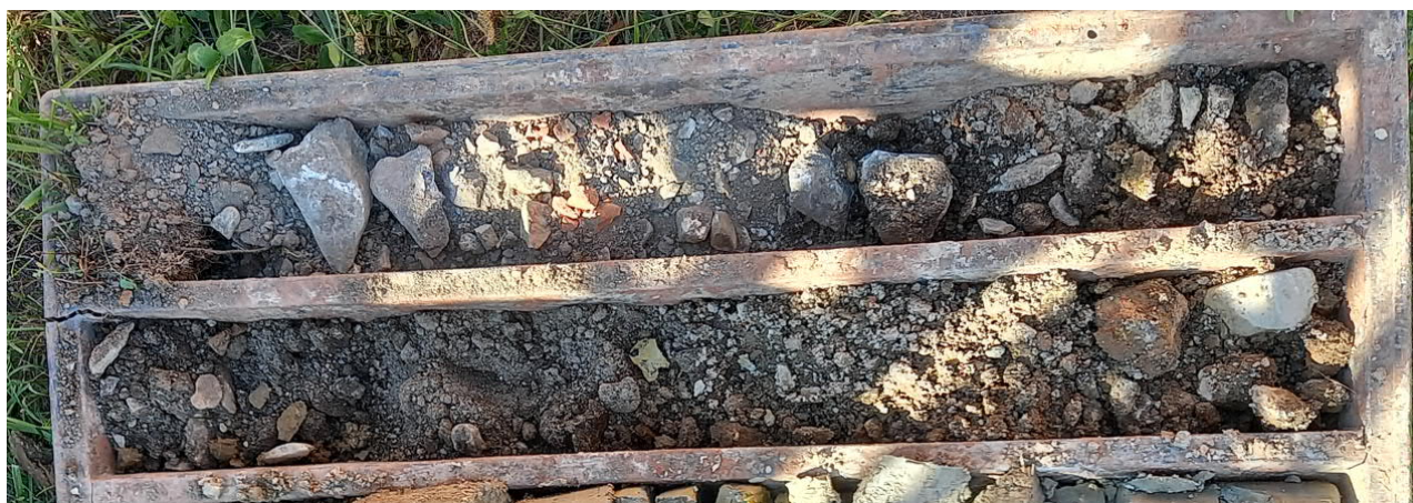
Obr. 4 Antropogenní navážky zastižené sodnou CHJ-2 (0 – 2,0 m)
