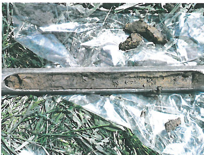
Foto č. 4: Výnos poloporušených vzorků zemin z vrstvy 1,0 m až 1,5 m pod terénem.
