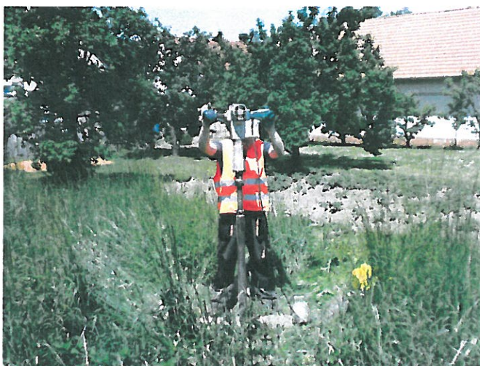
Foto č. 3: Hloubení průzkumné geologické sondy GS-1 v prostoru zamýšleného vsakovacího objektu.
