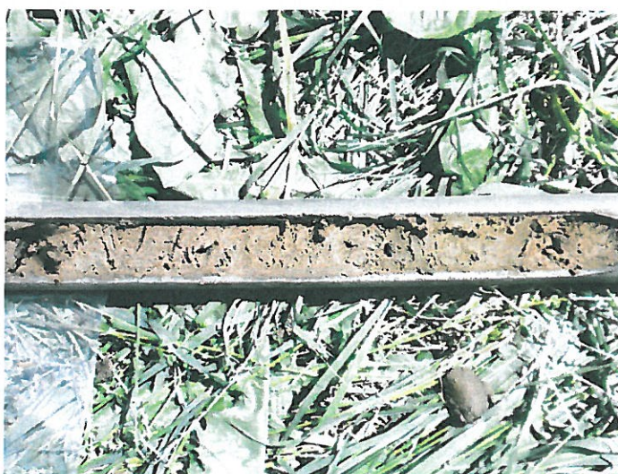
Foto č. 5: Výnos poloporušených vzorků zemin z vrstvy 1,5 m až 2,0 m pod terénem.
