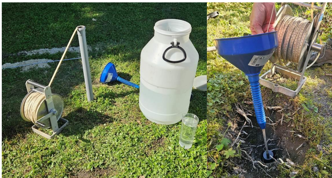
Obrázek č. 4 Vsakovací zkoušky na kopaných sondách na zájmové lokalitě
