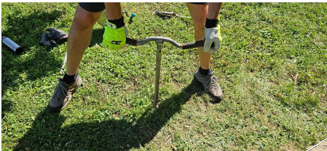
Obrázek č. 4 Vsakovací zkoušky na kopaných sondách na zájmové lokalitě
