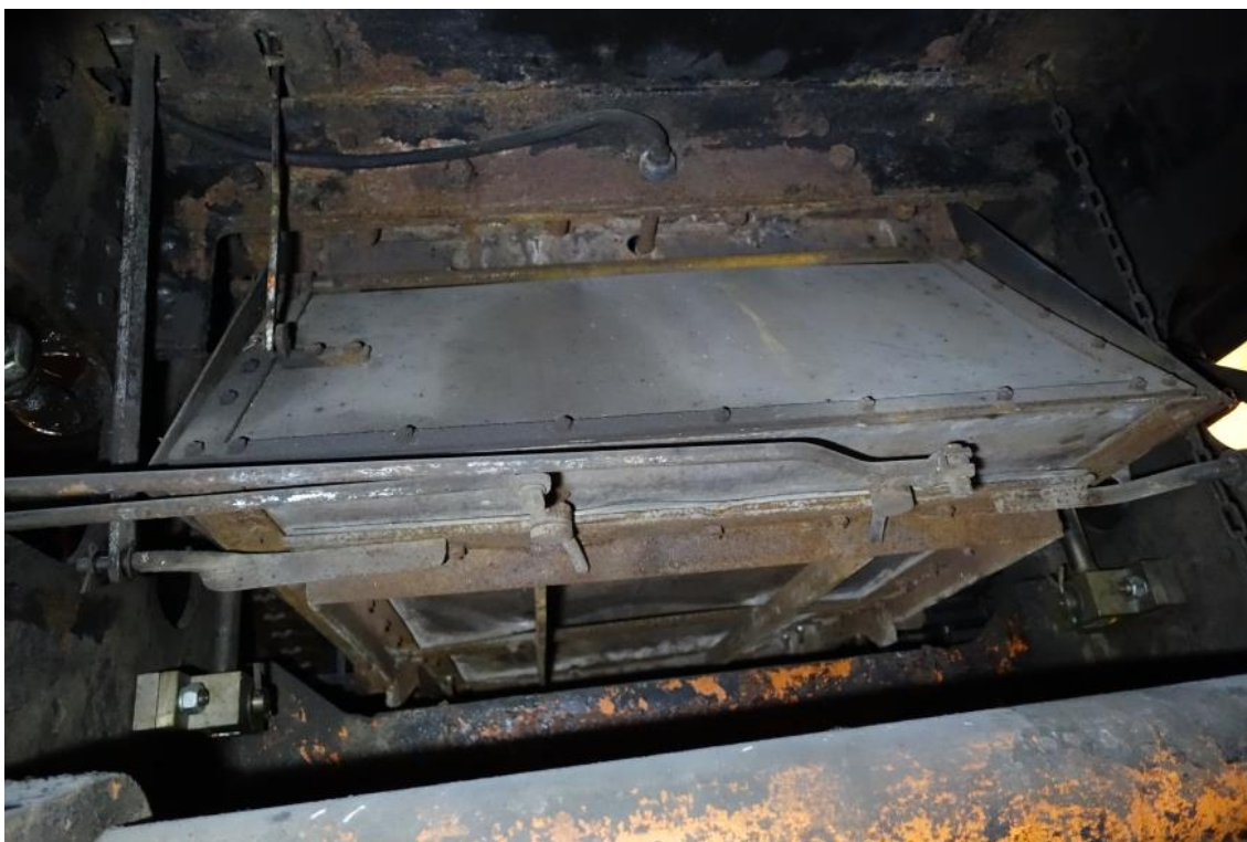
Obr. 7.3. - 2 Popelník je ve spodní části deformován žářem. Dno se musí vyrobít nové.
