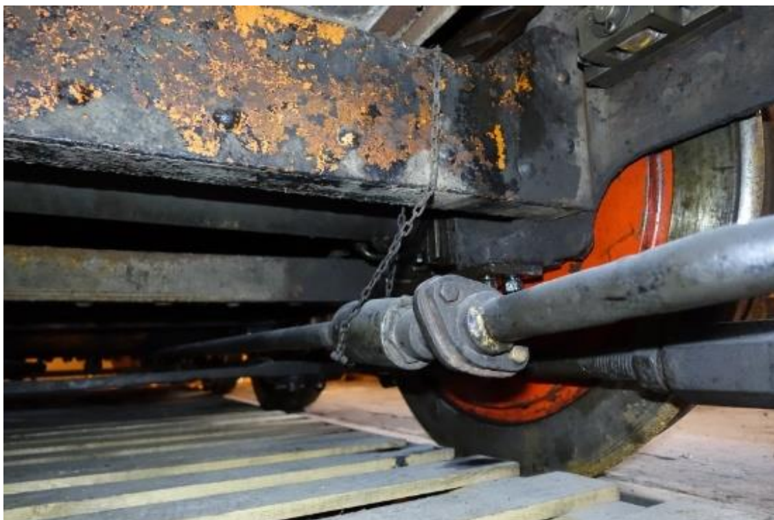
Obr. 7.3. - 16 Pod rámem vedou vodní potrubí k nyní již odmontovaným nasacím injektorům. Obě trubky se odstraní a příruby na dně vodojemu se zaslepí.
