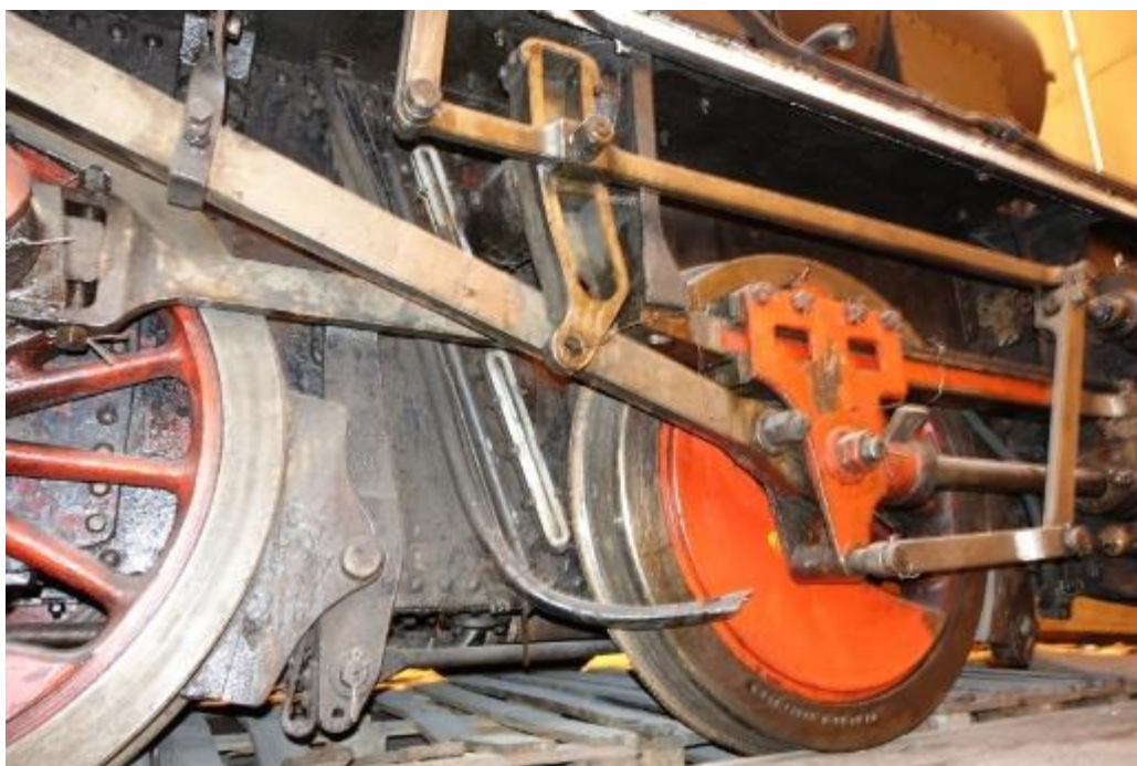
Obr. 7.3. - 20 Dodatečně montovaný průhledítkový stavoznak vodojemu sice není na chlubení, ale doporučuji jej zachovat, neboť narušil od zkoušecích kohoutků na levém boku lokomotivy umožňuje bezproblémovou kontrolu hladiny ve vodojemu.
