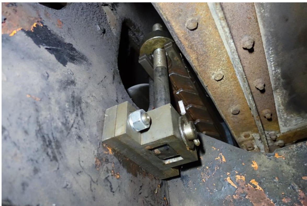
Obr. 7.2. - 10 Náprava S 2 dostala při opravě nové kozlíky vypružení.
