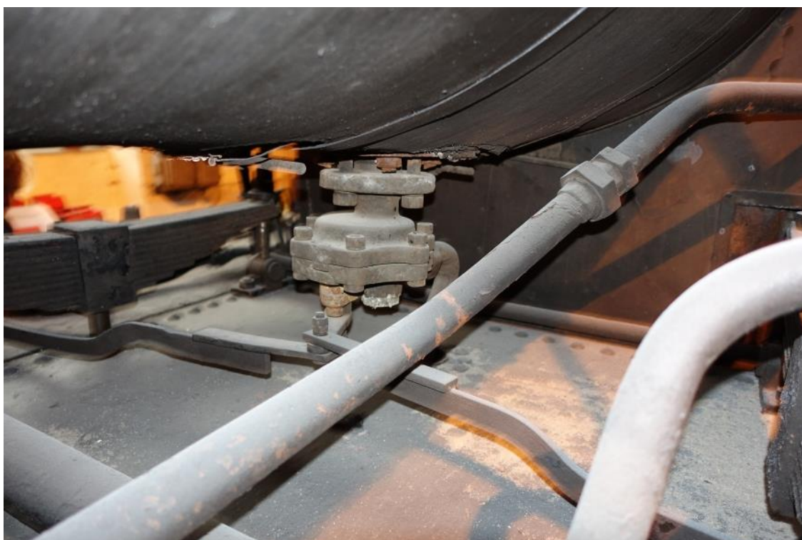
Obr. 7.3. - 6 Odkalovací šoupátko na břiše válcového kotle má oboustranné ovládání. Ponechá se jen to vedoucí na pravou stranu.
