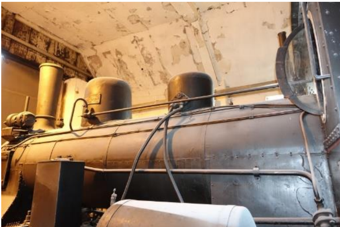
Obr. 7.3. - 15 Plechové obaly kotle bude nutné vyrobiť z väčších častí nových. Zejména ve spodní části a na stanovišti čtyř jsou poškozené korozí.
