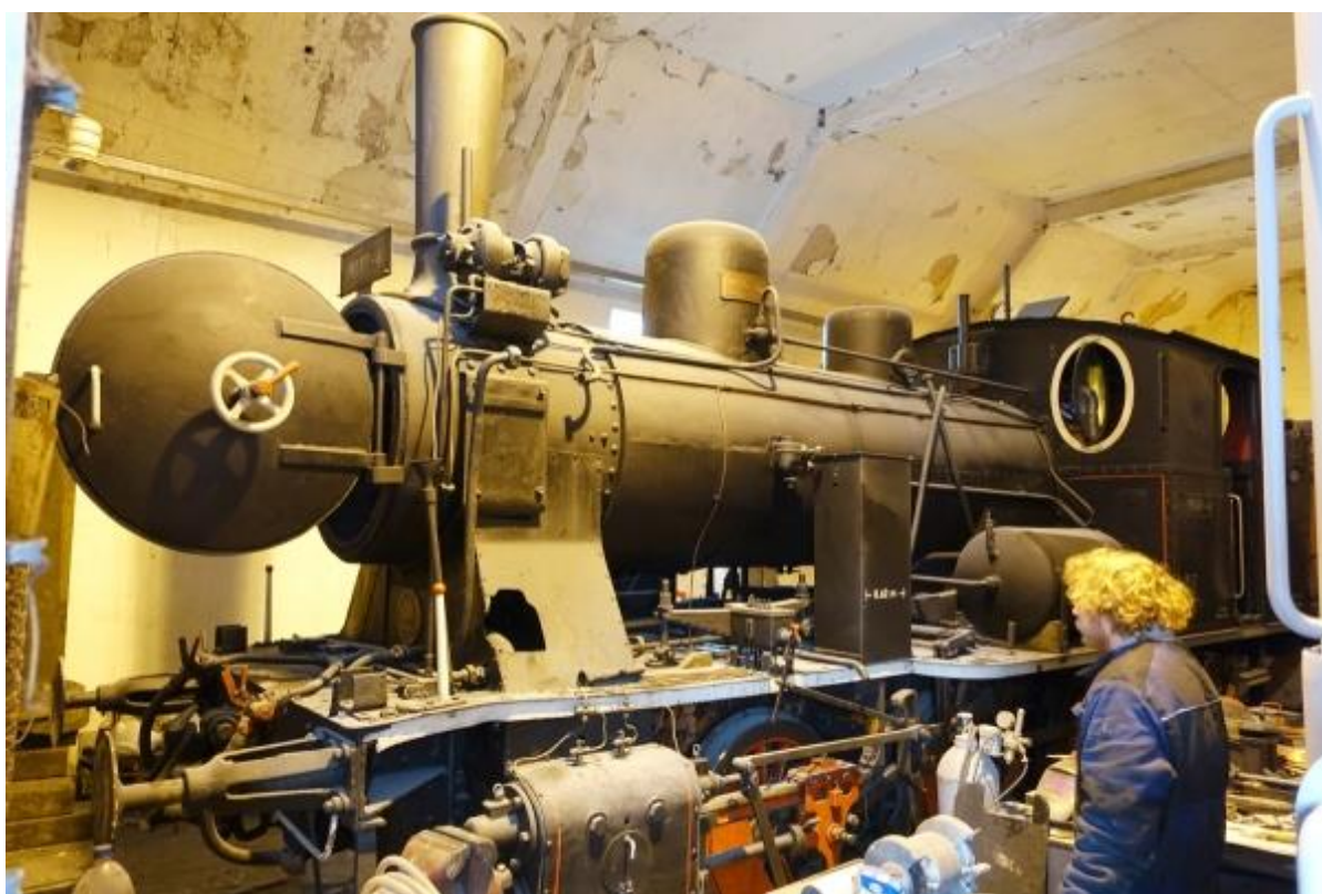
Obr. 9 Lokomotiva postrádá kompresor tlakové brzdy, který bude nutné nahradit jiným.
