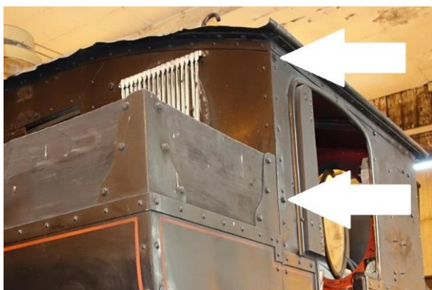
Obr. 7.3. - 36, 37 Na zadní hraně budky chybí madlo, po němž zůstaly jen otvory uzavřené šrouby (šipky). Madlo se vyrobí podle tovární fotografie.
