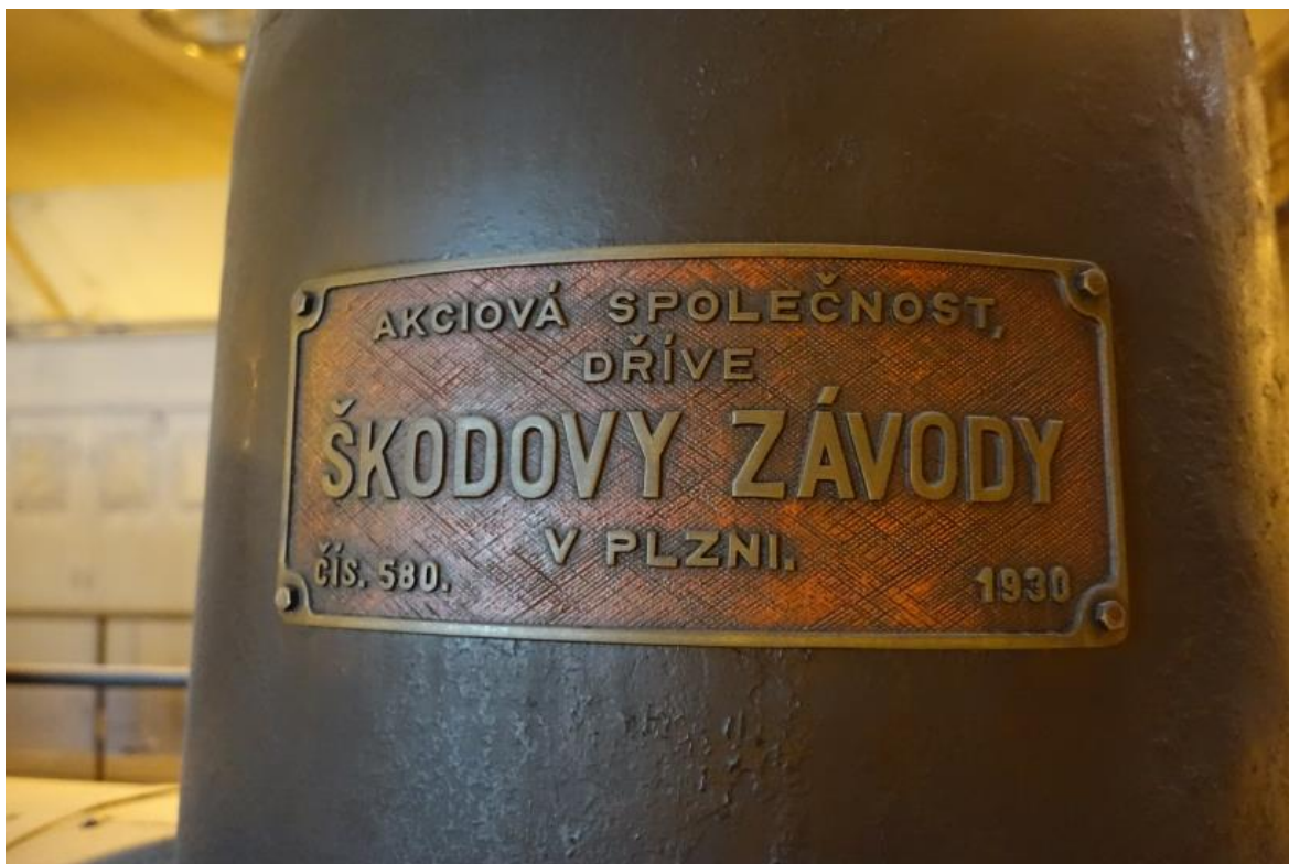
Obr. 7.3. - 43 Tovární štítky zachované oboustranně na parním dómu se vyčistí a červená půda nahradí černou.
