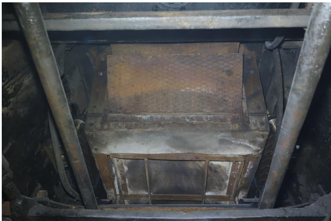
Obr. 7.3. - 4 Přední klapka popelníku (z rýhovaného plechu) byla vytvořena dodatečně kvůli spolehlivému chlazení roštnic pod trubkovnicí. Ovládá se z ochozu pomocí řetízku.
