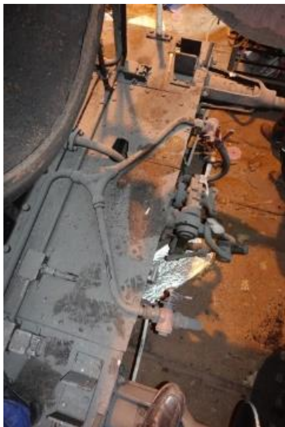
Obr. 7.3. - 30 Ze stejných důvodů jako na předchozím obrázku doporučuji prověřit možnost vést lépe i vzduchové potrubí na čele lokomotivy.
