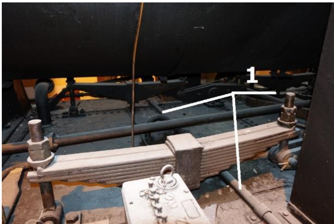
Obr. 7.3. - 17 Odvzdušnění vodojemu (1) je vedeno na pravý i levý bok lokomotivy. Vyrobí se nové a povede jen na pravou stranu.
