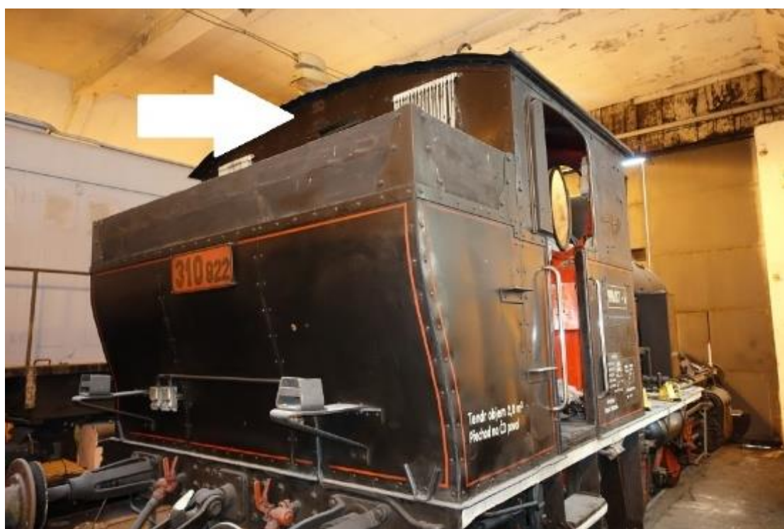
Obr. 7.3. - 31 Po nosiči návěštní lampy na zadním čele budky zůstal jen obtisk (šipka). Krakorec i všechny lucerníky lamp se vyrobí nové.
