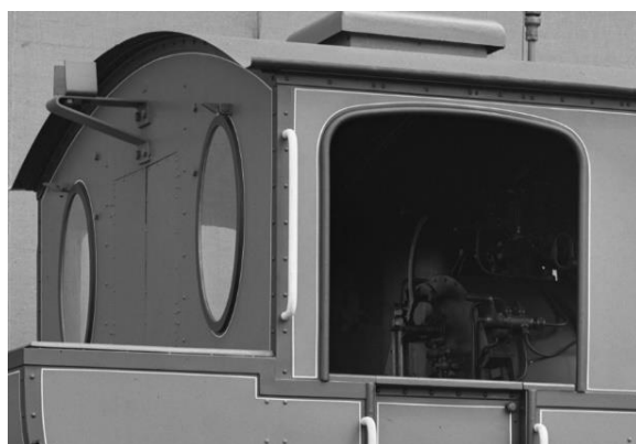
Obr. 7.3. - 36, 37 Na zadní hraně budky chybí madlo, po němž zůstaly jen otvory uzavřené šrouby (šipky). Madlo se vyrobí podle tovární fotografie.
