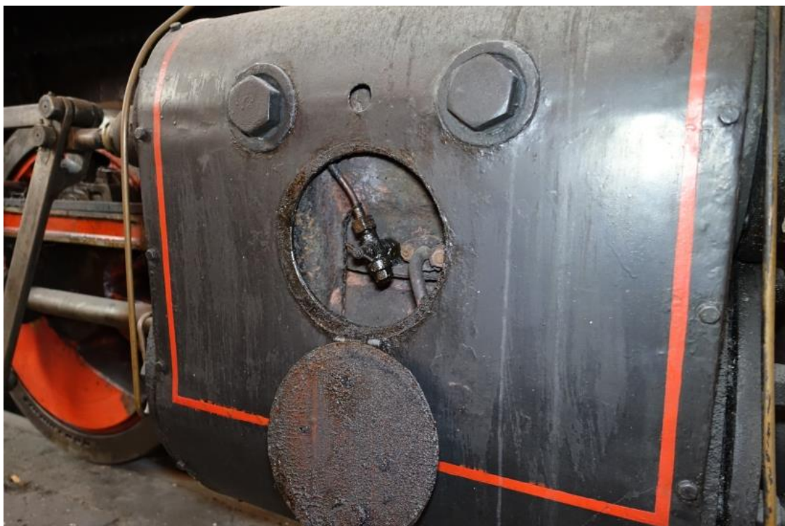
Obr. 7.3. - 28a Zaústění mazací trubky do válce je schováno pod víčkem. I zde je zpětný ventil kombinovaný s jehlovým zkoušecím ventilkem.
