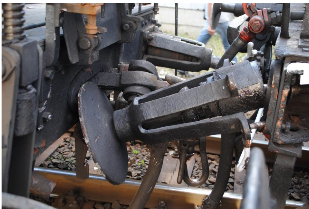
Obr. 7.2. - 2 Detail ulomeného předního nárazníku. (foto ŽM NTM)
