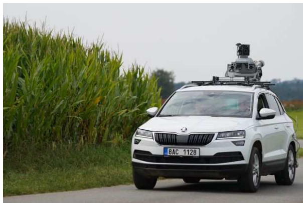
Obrázek 9: Mobilní mapovací vozidla (GEOVAP, spol. s r.o., GEODROM s.r.o.)
