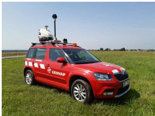
Obrázek 9: Mobilní mapovací vozidla (GEOVAP, spol. s r.o., GEODROM s.r.o.)
