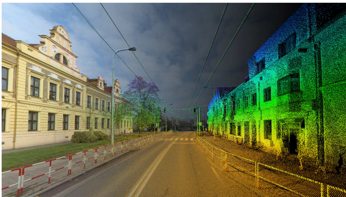
Obrázek 14: Panoramatické foto a laserové mračno bodů
