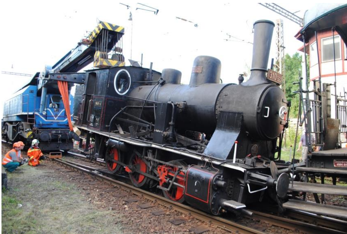
Obr. 7.2. - 5 Vyprošťování lokomotivy nehodovým jeřábem. (foto ŽM NTM)
