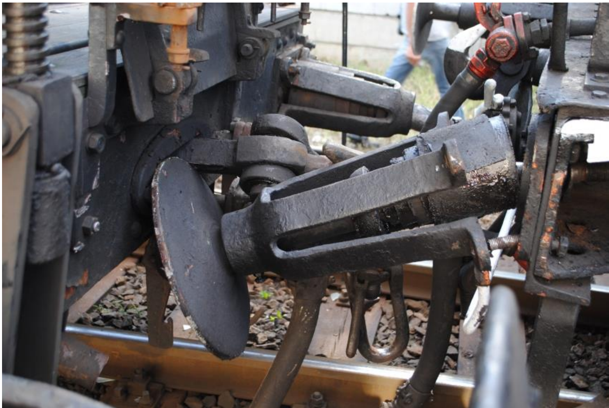
Obr. 7.2. - 2 Detail ulomeného předního nárazníku. (foto ŽM NTM)
