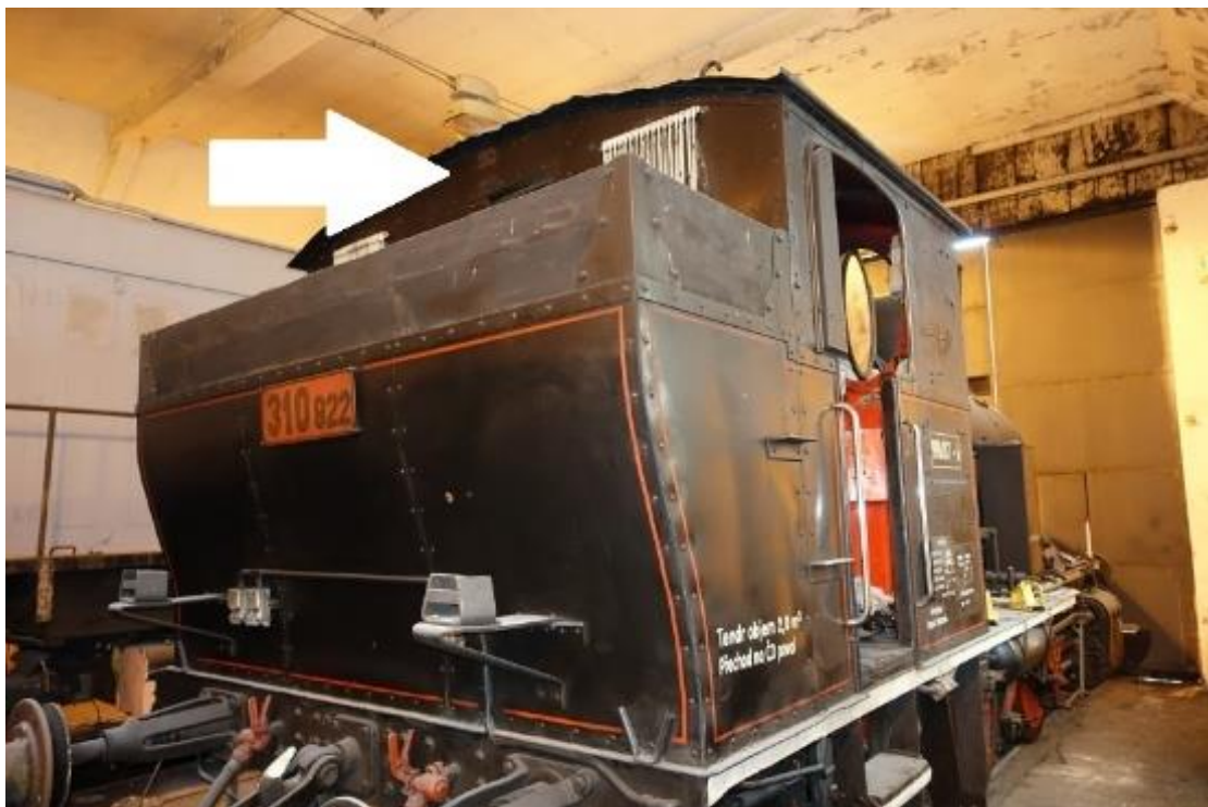
Obr. 7.3. - 31 Po nosiči návěsní lampy na zadním čele budky zůstal jen obtisk (šipka). Krakorec i všechny lucerníky lamp se vyrobí nové.
