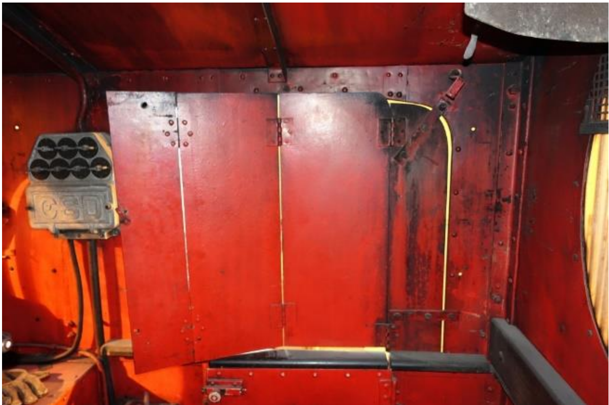
Obr. 7.3. - 40 Skládací plechové zástěny zakrývající výřezy nad dvířky v bocích budky se nahradí závěsem z plachtoviny.
