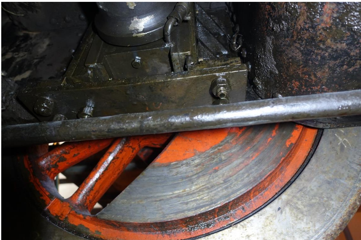
Obr. 7.2. - 8 Dlouhá jízda lokomotivy mimo kolej se projevila mj. i odřením protizávaží na všech kolech.
