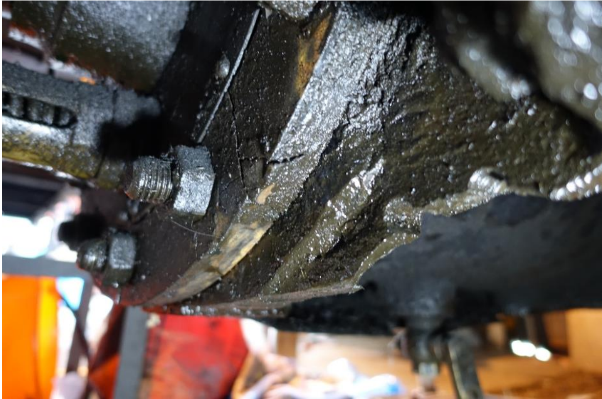
Obr. 7.2. - 7 Na zadním víku levého bloku válců je dosud patrný otisk kolejnice, na níž víko narazilo. Přitom došlo k jeho popraskání. Vpravo je odlomené žebro bloku, kde bylo pomocí dvou šroubů upevněno oko nesoucí hřídel odvodňovacích kohoutů.
