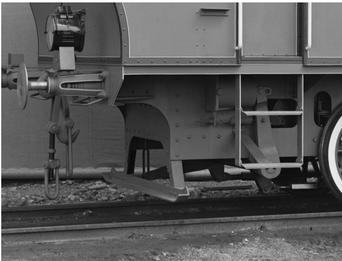
Obr. 7.3. - 21 Při výrobě náhrad za zničená smetadla se lze řídit továrními fotografiemi typu Cs10 i Bs12.
