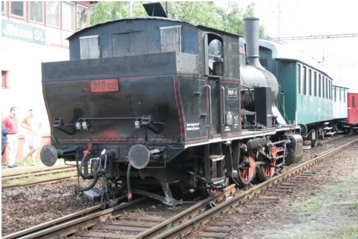
Obr. 7.2. - 3 Lokomotiva po nehodě. Pod rámem je vidět zničené zadní smetadlo. (foto ŽM NTM)
