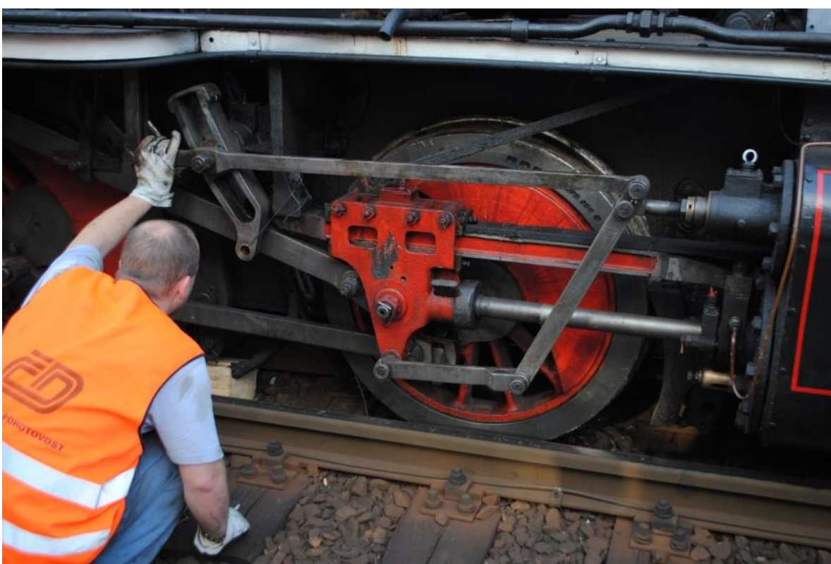
Obr. 7.2. - 6 Výše položené součásti pohonu a rozvodu parního stroje nebyly násilným poškozením zasaženy. (foto ŽM NTM)
