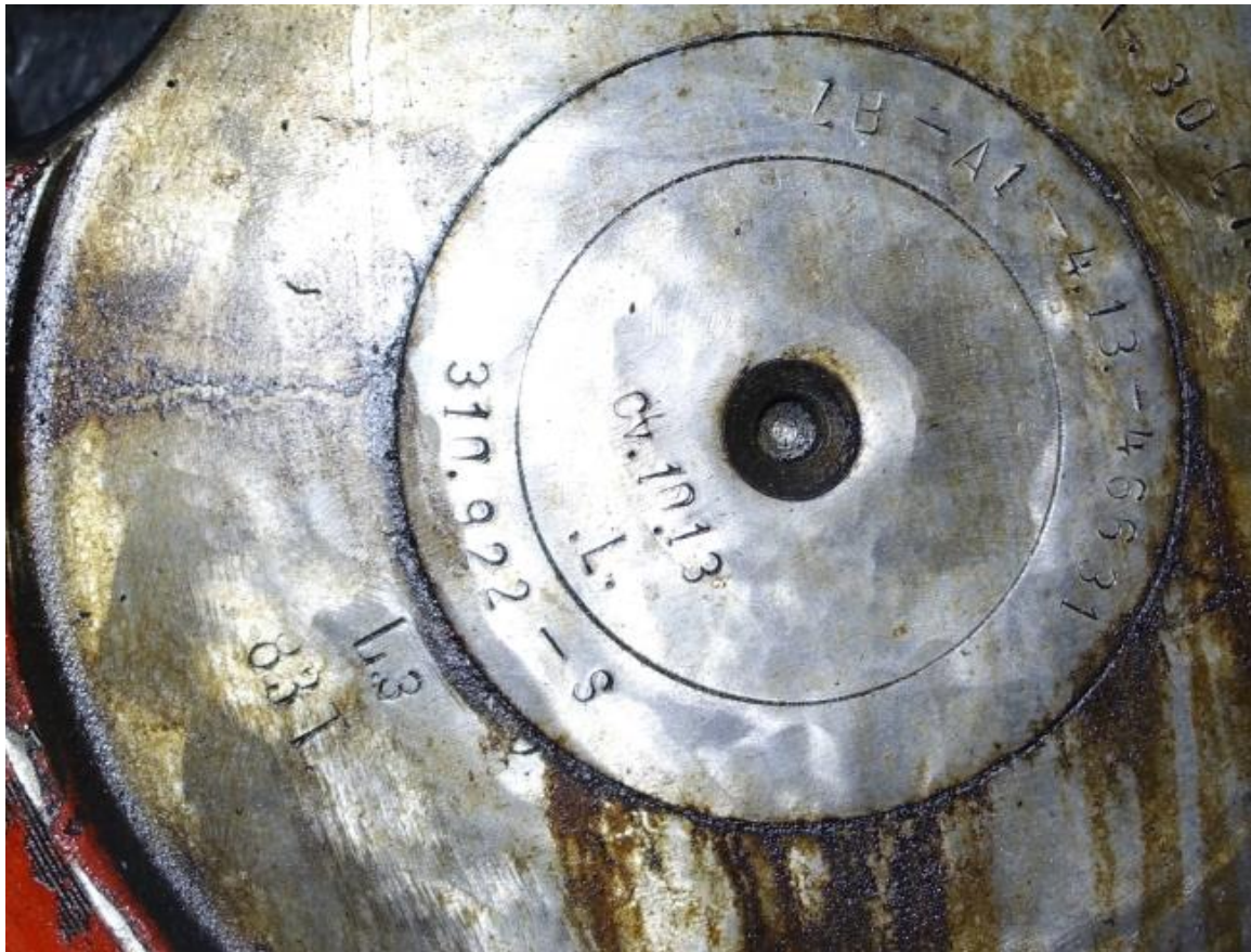
Obr. 7.2. - 9 Čela náprav H a S 2 nesou raznicí vyznačený říjen 2013, kdy byly nově vyrobeny v ŽOS České Velenice.
