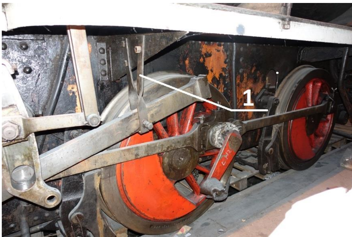
Obr. 7.3. - 26 Transportní závěsy pro ojnice (1) výrazně usnadňují studené přepravy, a proto je doporučují uschovat ve výzbroji lokomotivy.
