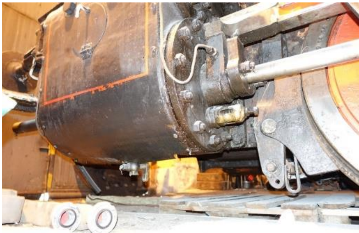
Obr. 7.3. - 25 Ulámané a ztracené odvodňovací kohouty se vyrobí podle jediného kusu zachovaného na levém válci. Pojistné ventily na víkách válců postačí vyčistit a zabrousit.
