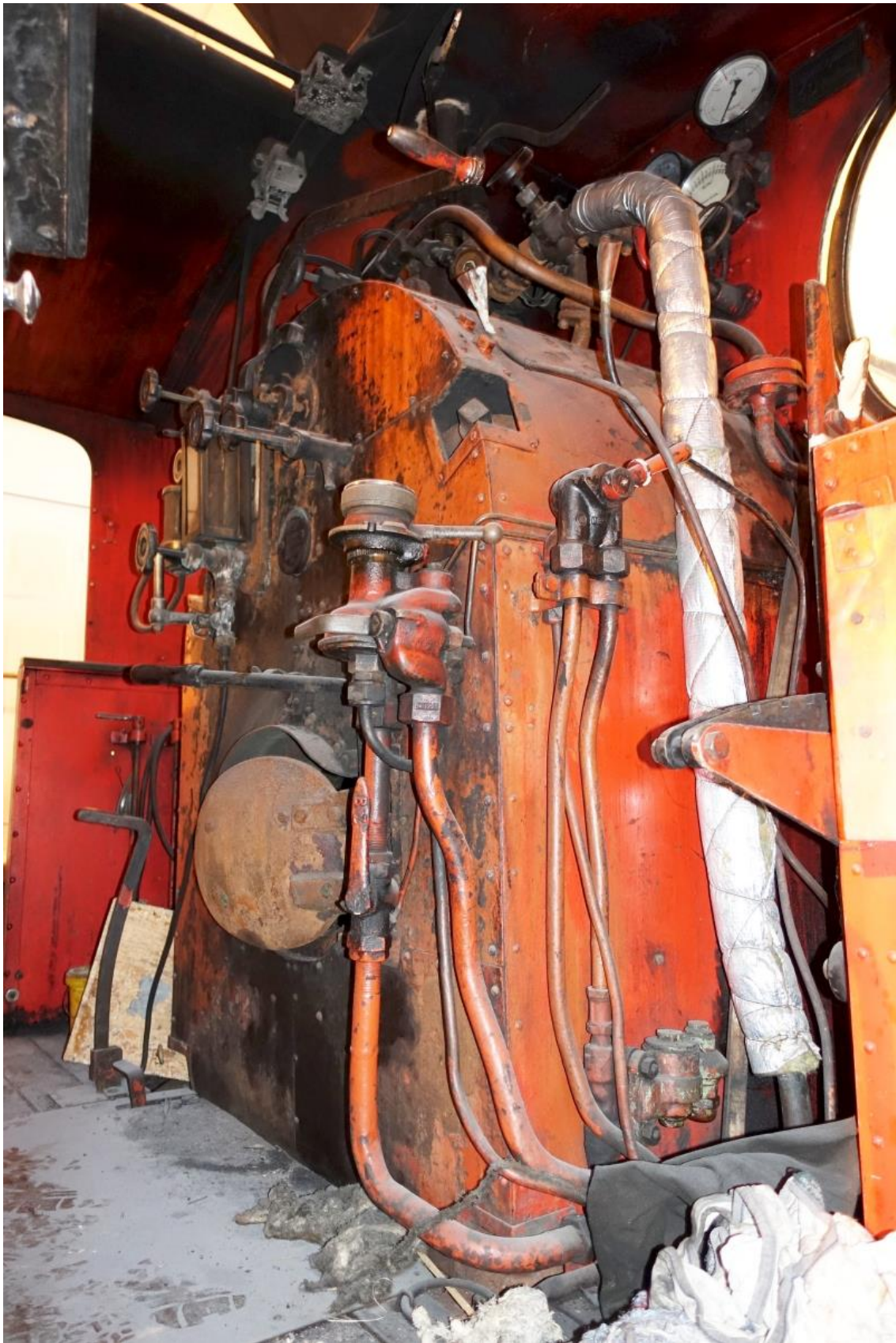
Obr. 10 Pohled na stanoviště z pravé strany. Plechový obal skříňového kotle s netypickými ostrými hranami je původní.
