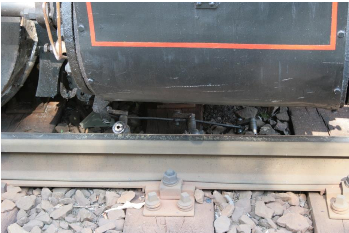
Obr. 7.2. - 4 Detail ulámaných odvodňovacích kohoutů pravého válce. (foto ŽM NTM)
