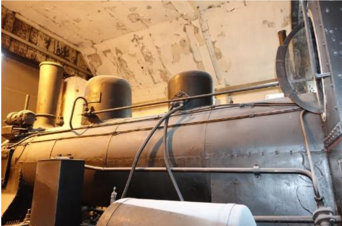
Obr. 7.3. - 15 Plechové obaly kotle bude nutné vyrobit z větší části nové. Zejména ve spodní části a na stanovišti čtyř jsou poškozené korozí.
