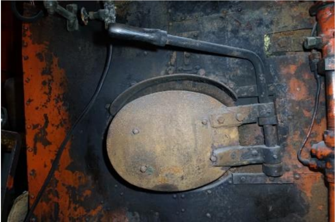
Obr. 7.3. - 13 Topná dvířka mají žárem deformované závěsy, nedoléhají správně na topný otvor a zároveň neumožňují přívod sekundárního vzduchu. Provede se rekonstrukce.
