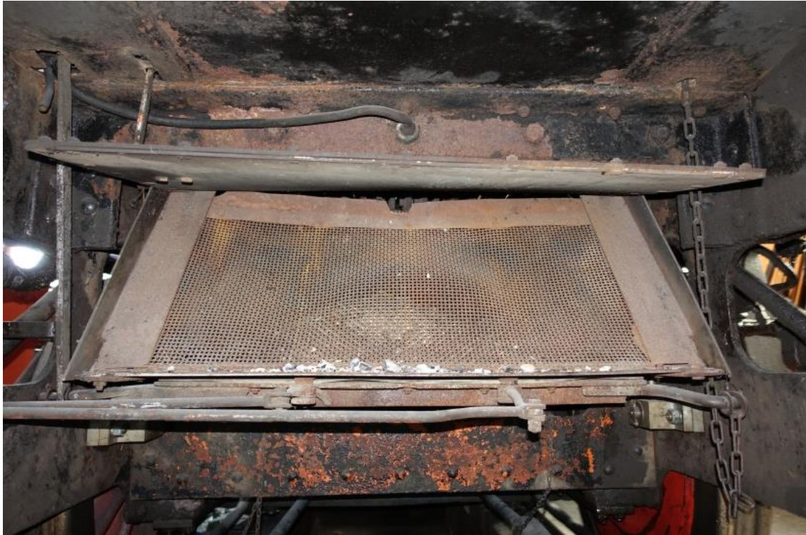
Obr. 7.3. - 3 Síto pod vzduchovou klapkou popelníku se kompletně obnoví. V popředí jsou patrná dvě táhla k obtlíkovému zajištění výklopného dna popelníku. Táhla je třeba zesílit.
