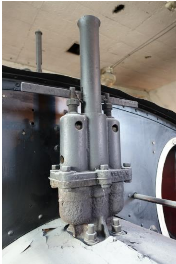
Obr. 7.3. - 14 V jistém smyslu raritou u našich lokomotiv jsou pojistné záklopy soustavy Ramsbottom. Jejich oprava a přezkoušení ale nebude činit problémy.
