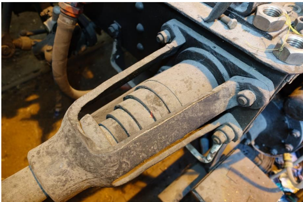
Obr. 7.2. - 11 Nárazník ulomený při nehodě byl vrácen na své místo a upevněn novými šrouby.
