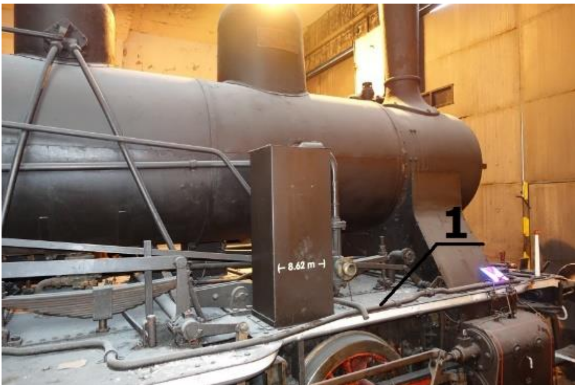
Obr. 7.3. - 29 V rámci opravy lokomotivy je nutné revidovat nejen počet, ale i způsob vedení různých potrubí z hlediska estetického i provozního. Trubka tlakové brzdy (1) vedoucí po hraně ochozu mimořádně ztěžuje pohyb čety při údržbě a činí jej nebezpečným. Trubka se přemístí pod kotel, případně se povede po jeho břiše.
