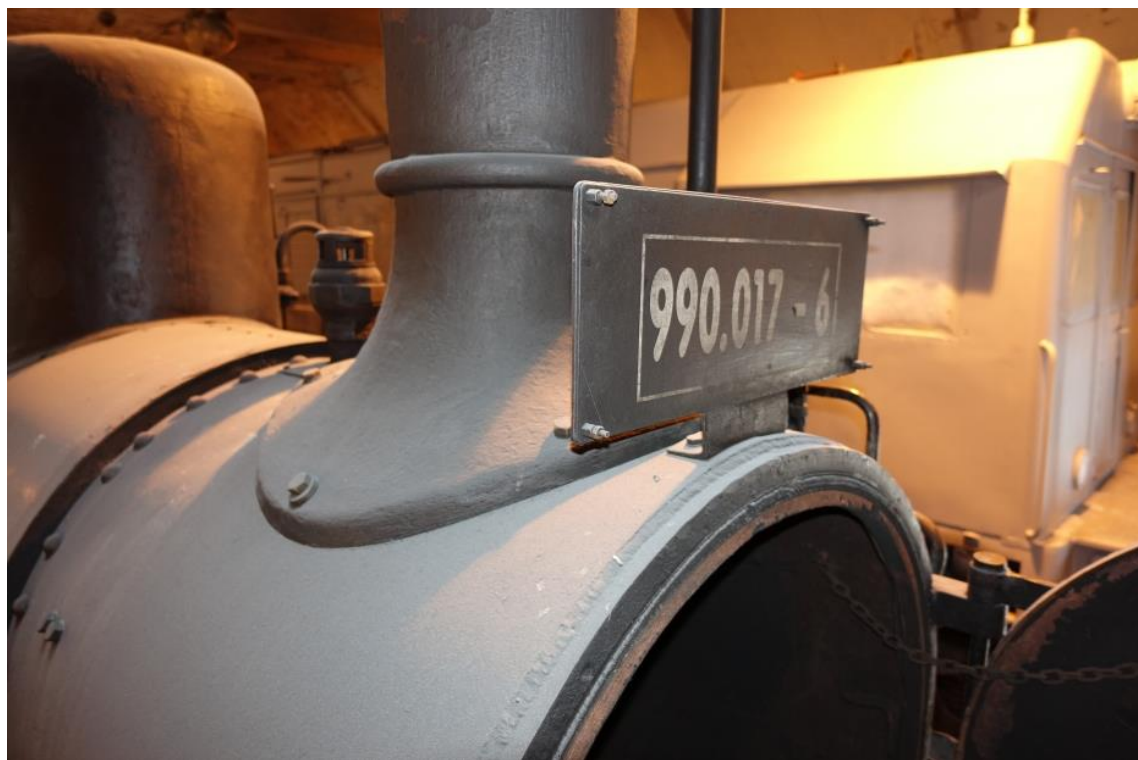
Obr. 7.3. - 8 Na přední hraně dýmnice je patrný svar. Hrana se doplní materiálem tak, aby byla ostrá jako v původním provedení. Zajímavé je, že již z továrny bylo čelo dýmnice svařované a nikoliv nýťované jako u strojů Bs12 nebo většiny jiných lokomotiv.
