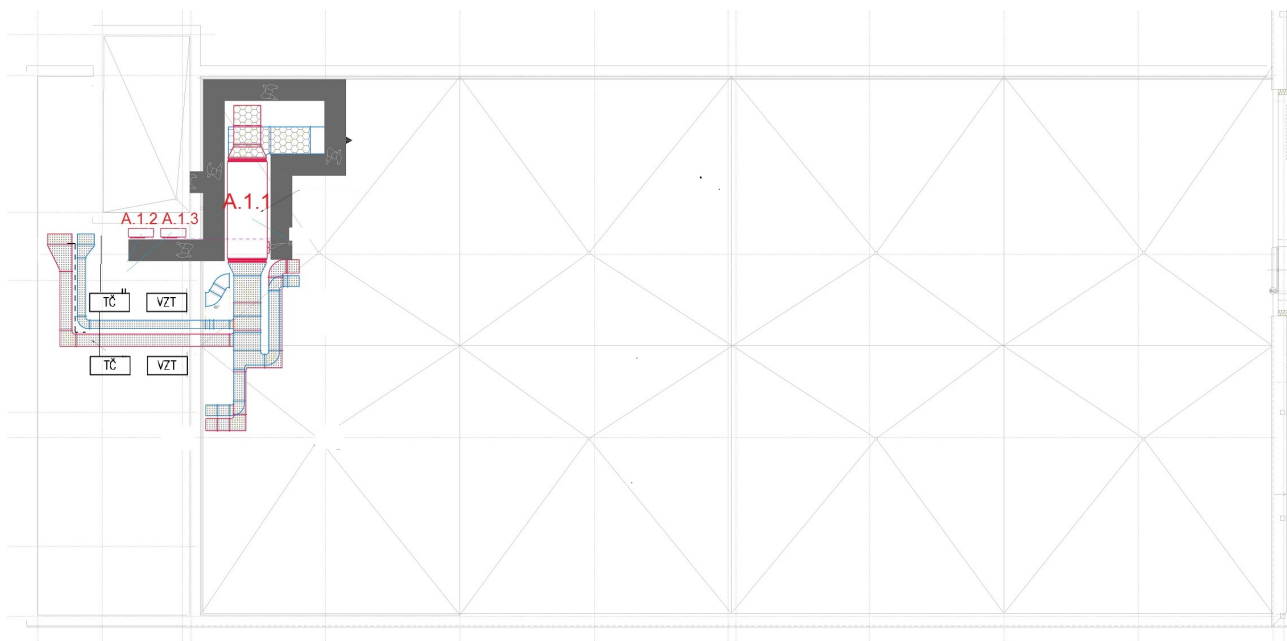
Obrázek 2: Poloha venkovních jednotek na střeše budovy A
