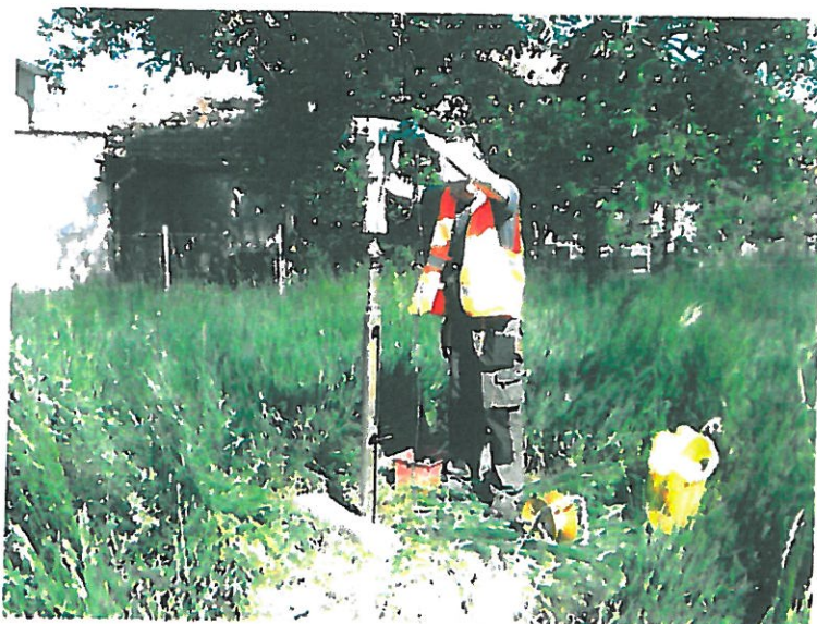
Foto č. 3: Hloubení průzkumné geologické sondy GS-1 ruční elektrickou vrtnou soupravou EIJKELKAMP.
