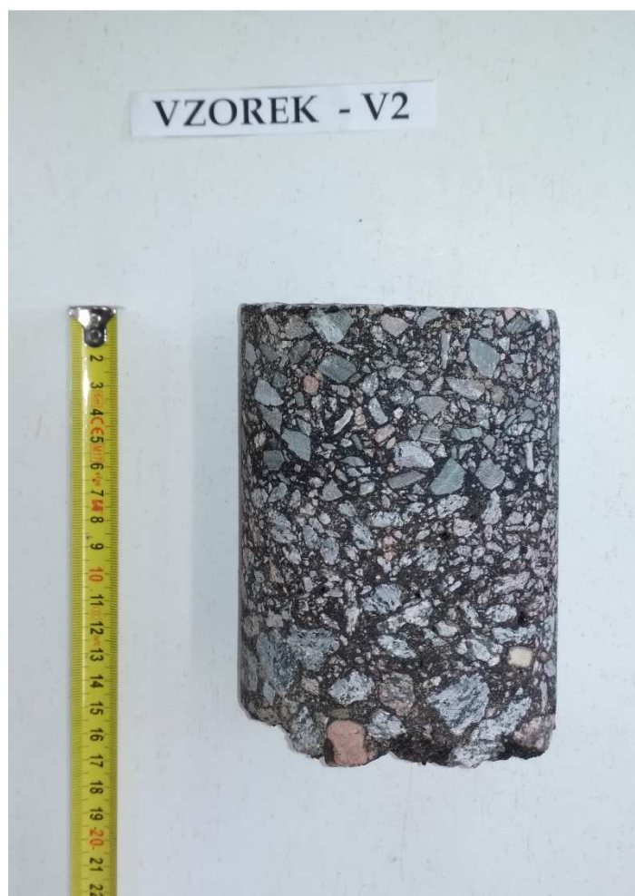
Obr. 4 - Jádro vývrtu Vzorek – V2 (laboratoř).
