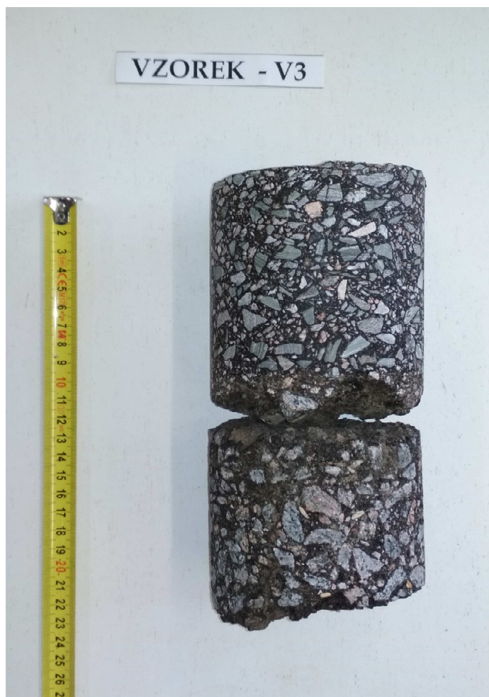
Obr. 6 - Jádru vývrtu Vzorek – V3 (laboratoř).
