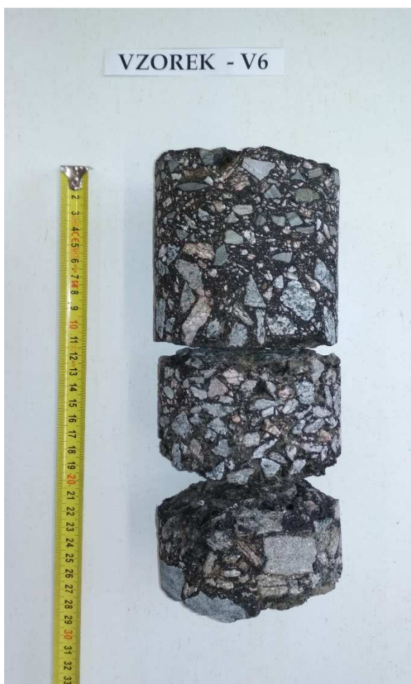
Obr. 12 - Jádro vývrtu Vzorek – V6 (laboratoř).
