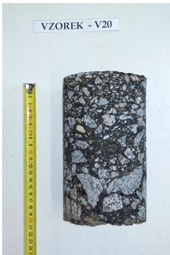
Obr. 40 - Jádru vývrtu Vzorek – V20 (laboratoř).
