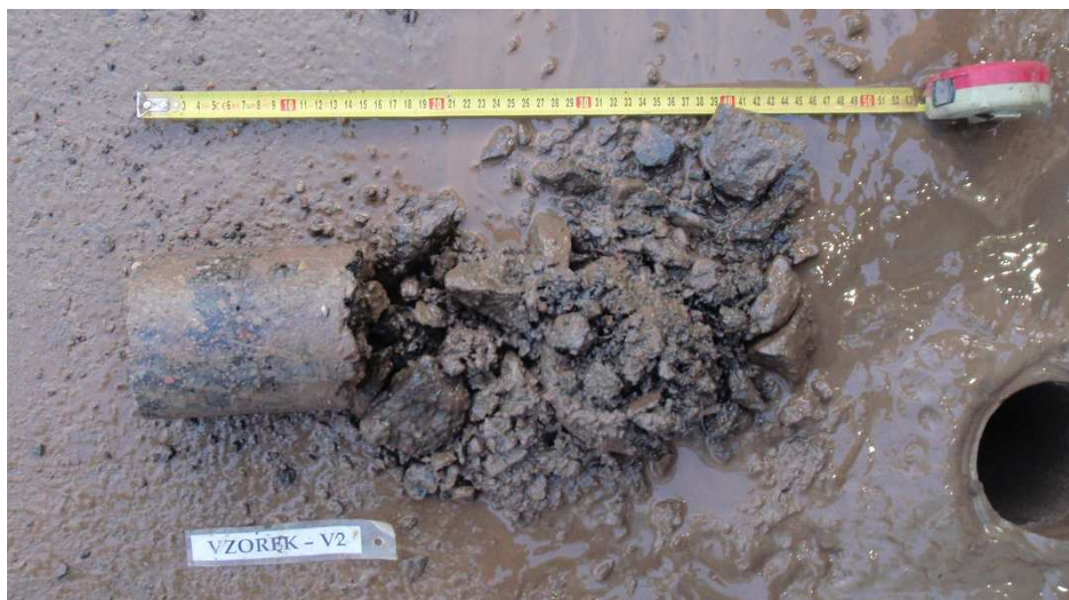
Obr. 3 - Jádro výtvetu Vzorek – V2 (in situ).
