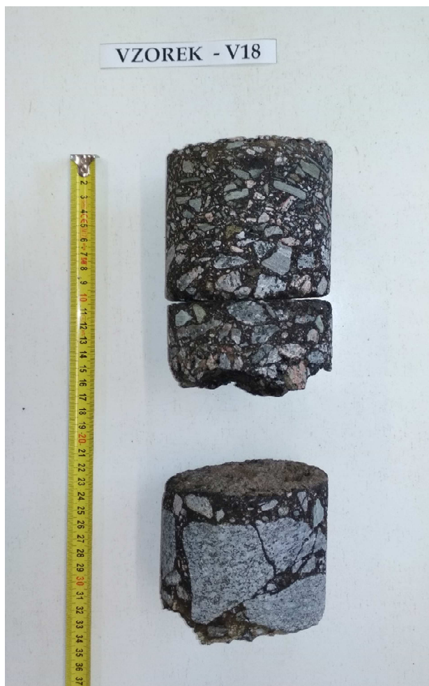
Obr. 36 - Jádro vývrtu Vzorek – V18 (laboratoř).
