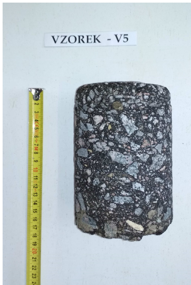
Obr. 10 - Jádro vývrtu Vzorek – V5 (laboratoř).
