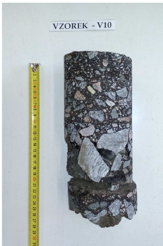
Obr. 20 - Jádro vývrtu Vzorek – V10 (laboratoř).
