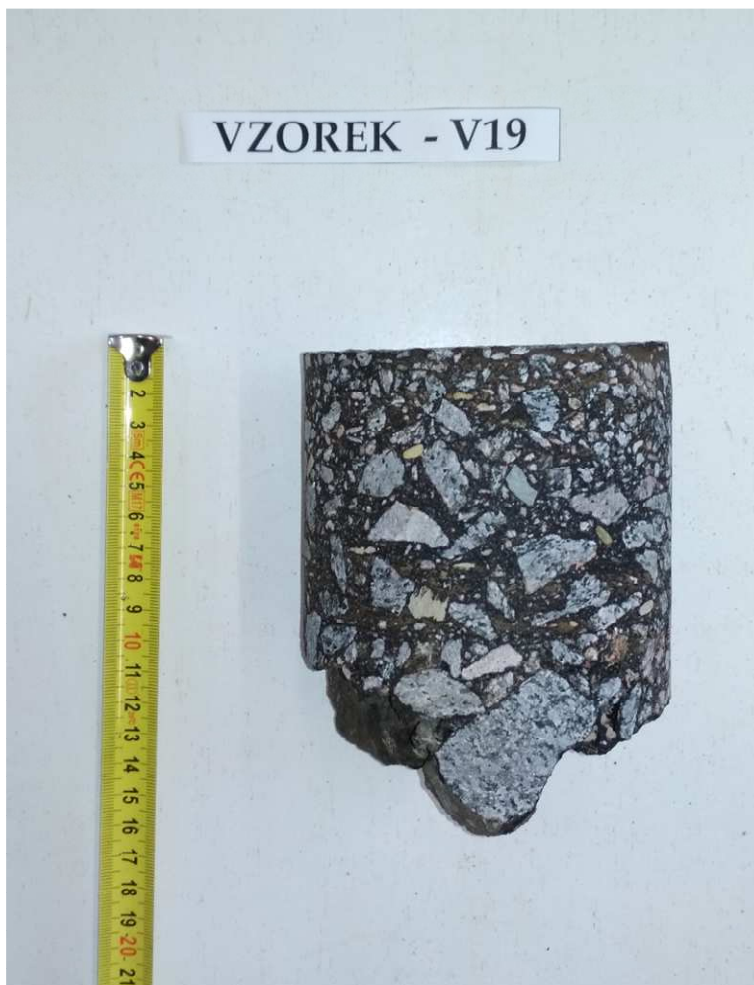
Obr. 38 - Jádro vývrtu Vzorek – V19 (laboratoř).
