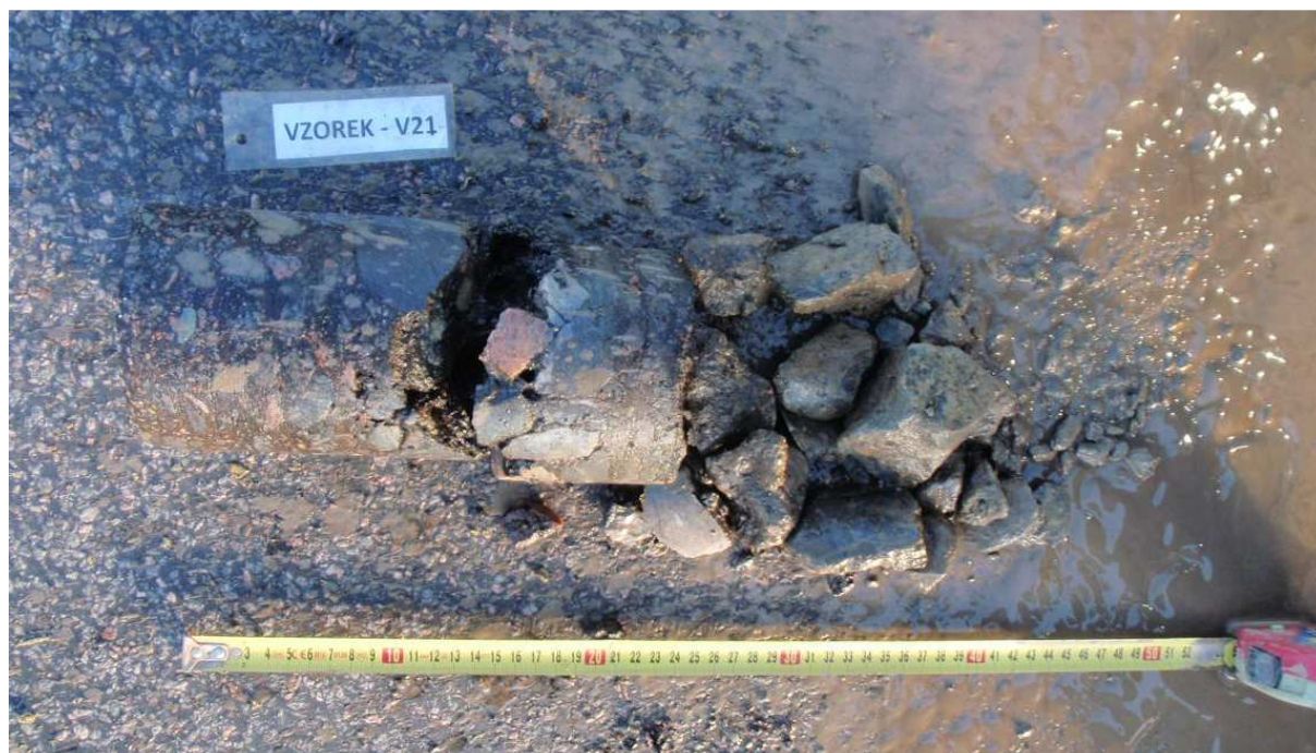
Obr. 41 - Jádro vývrtu Vzorek – V21 (in situ).
