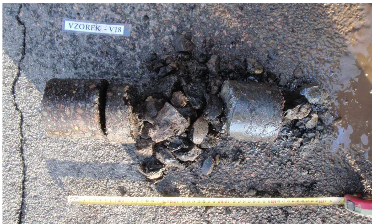
Obr. 35 - Jádro vývrtu Vzorek – V18 (in situ).
