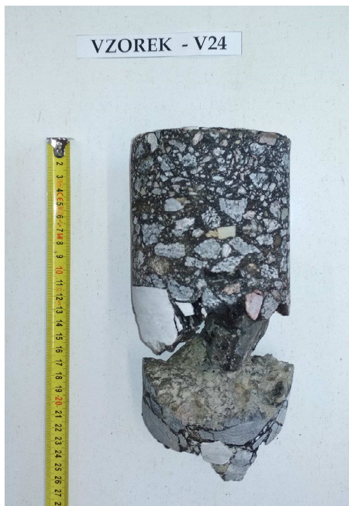
Obr. 48 - Jádro vývrtu Vzorek – V24 (laboratoř).
