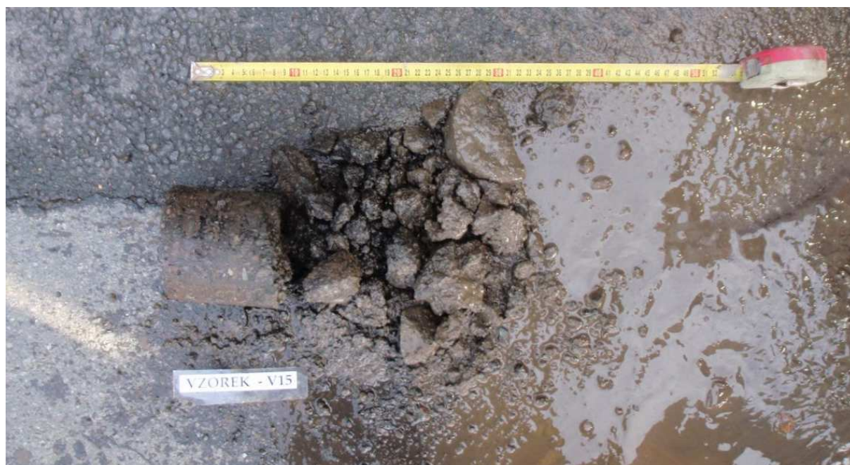
Obr. 29 - Jádro vývrtu Vzorek – V15 (in situ).
