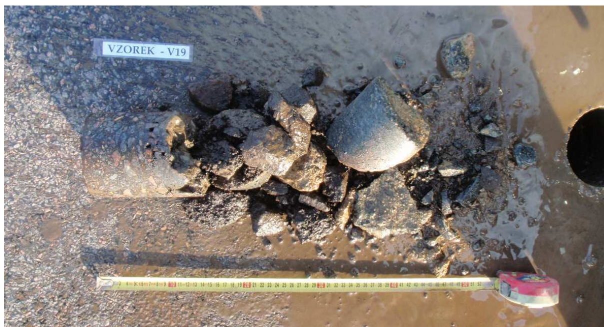
Obr. 37 - Jádro vývrtu Vzorek – V19 (in situ).
