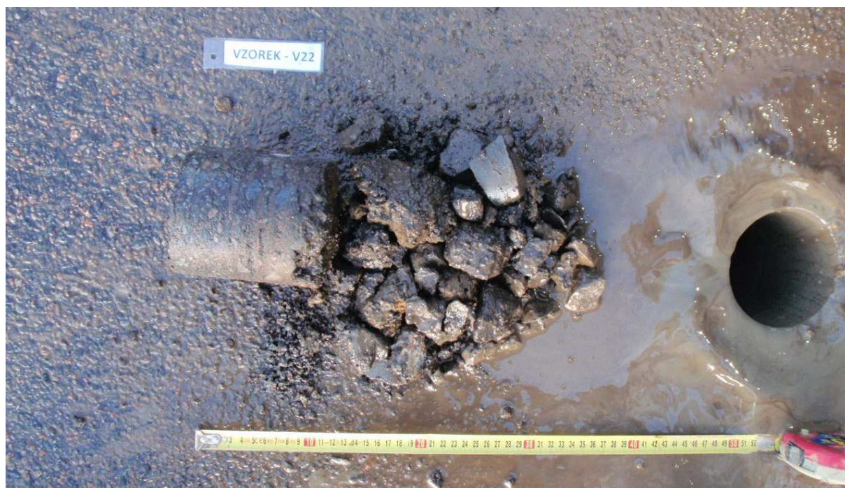
Obr. 43 - Jádro vývrtu Vzorek – V22 (in situ).
