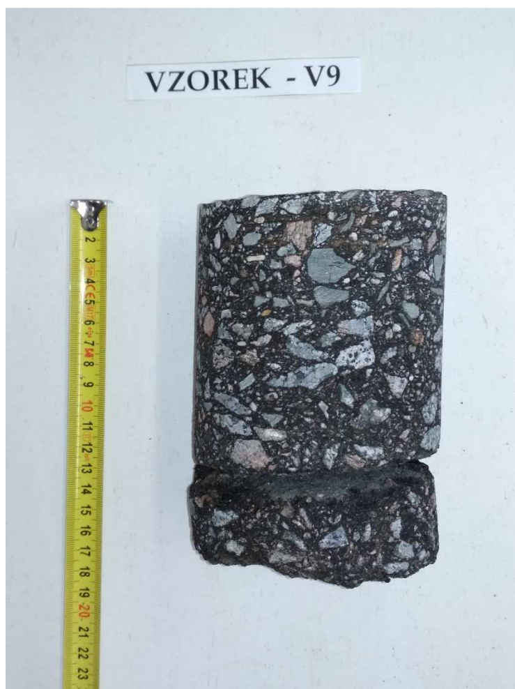
Obr. 18 - Jádro vývrtu Vzorek – V9 (laboratoř).
