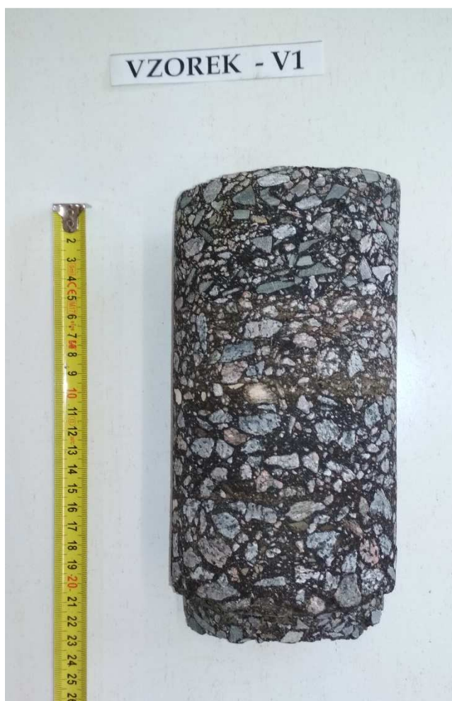
Obr. 2 - Jádru vývrtu Vzorek – V1 (laboratoř).
