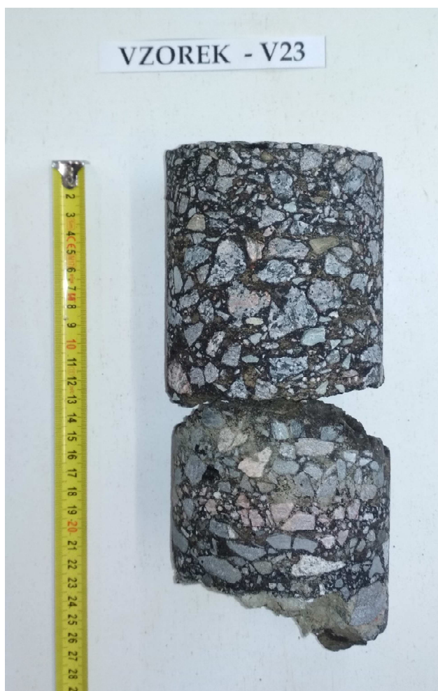
Obr. 46 - Jádru vývrtu Vzorek – V23 (laboratoř).
