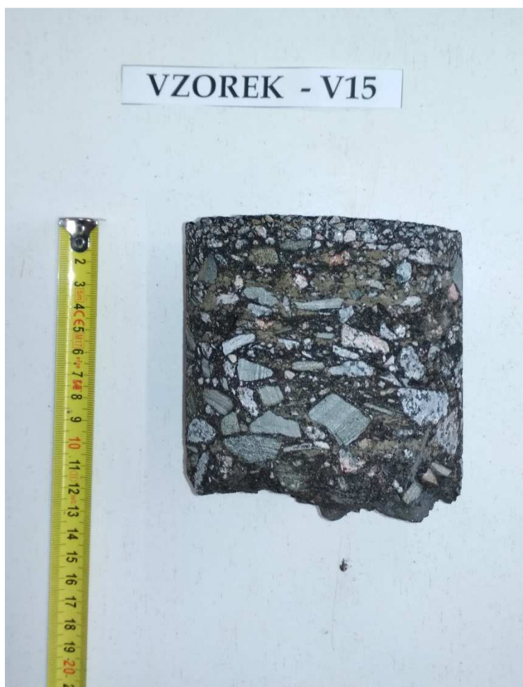
Obr. 30 - Jádru vývrtu Vzorek – V15 (laboratoř).
