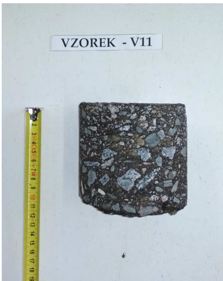
Obr. 22 - Jádro vývrtu Vzorek – V11 (laboratoř).
