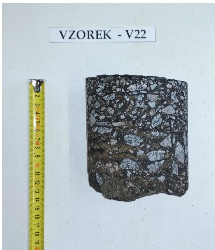
Obr. 44 - Jádru vývrtu Vzorek – V22 (laboratoř).
