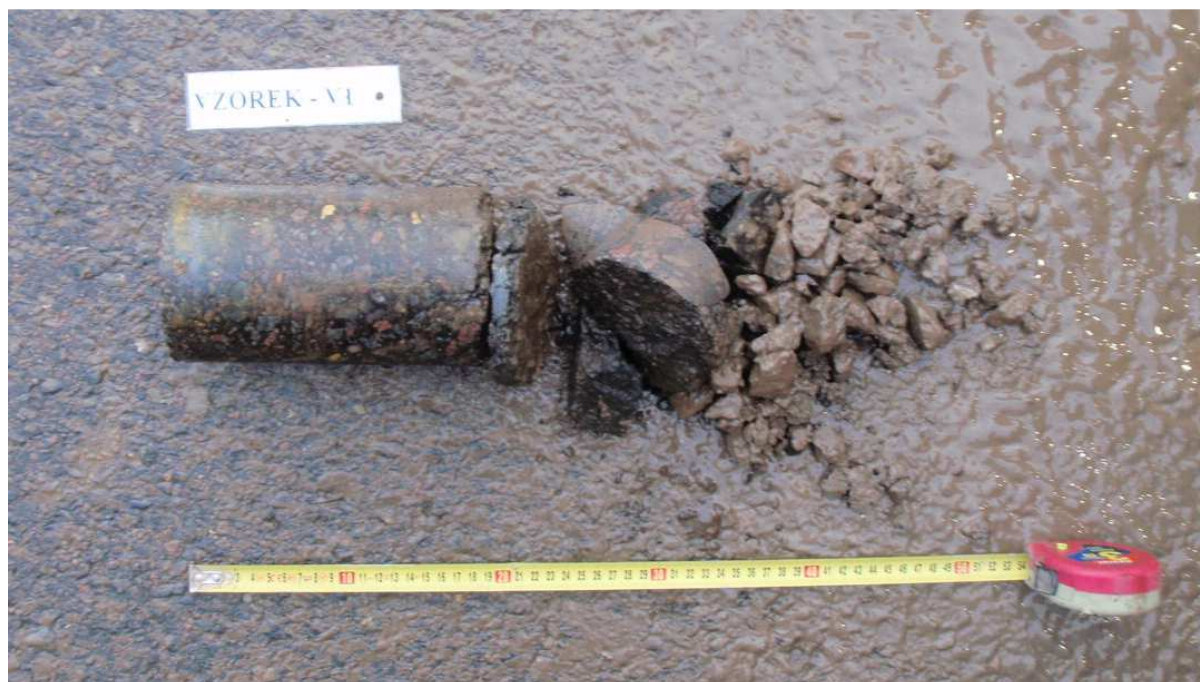
Obr. 1 - Jádro výtvetu Vzorek – V1 (in situ).
