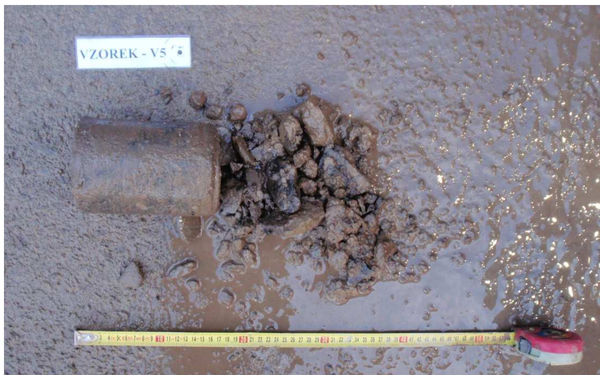
Obr. 9 - Jádro vývrtu Vzorek – V5 (in situ).
