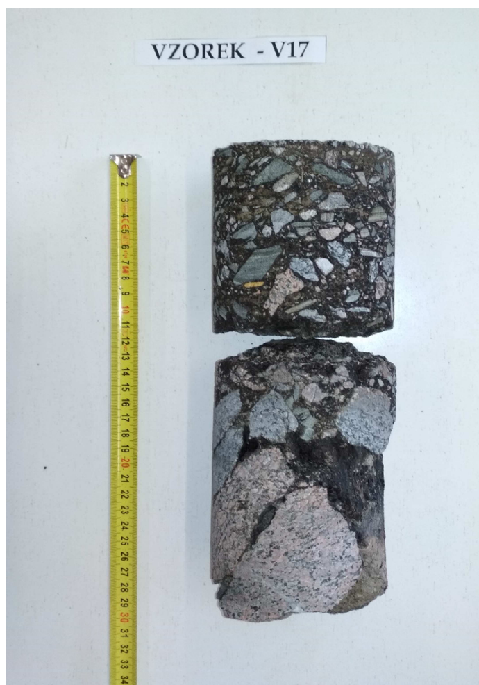
Obr. 34 - Jádru vývrtu Vzorek – V17 (laboratoř).
