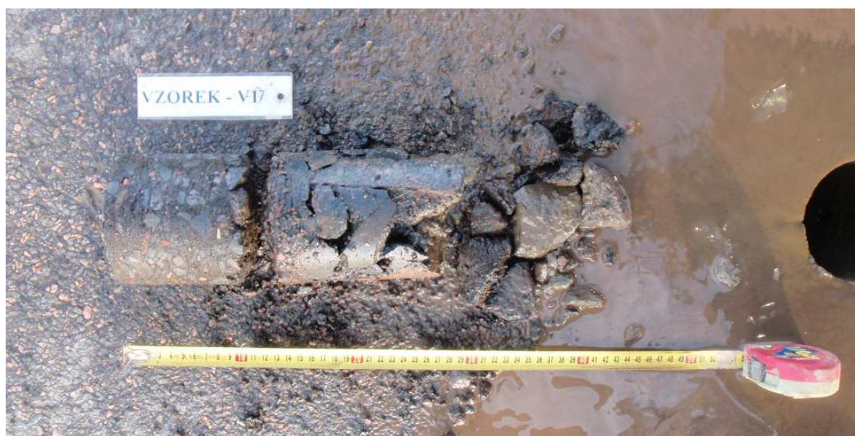
Obr. 33 - Jádro vývrtu Vzorek – V17 (in situ).
