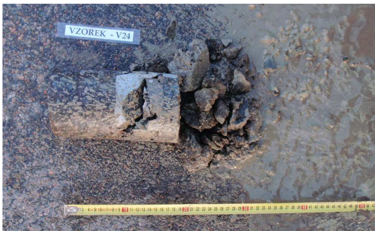
Obr. 47 - Jádro vývrtu Vzorek – V24 (in situ).
