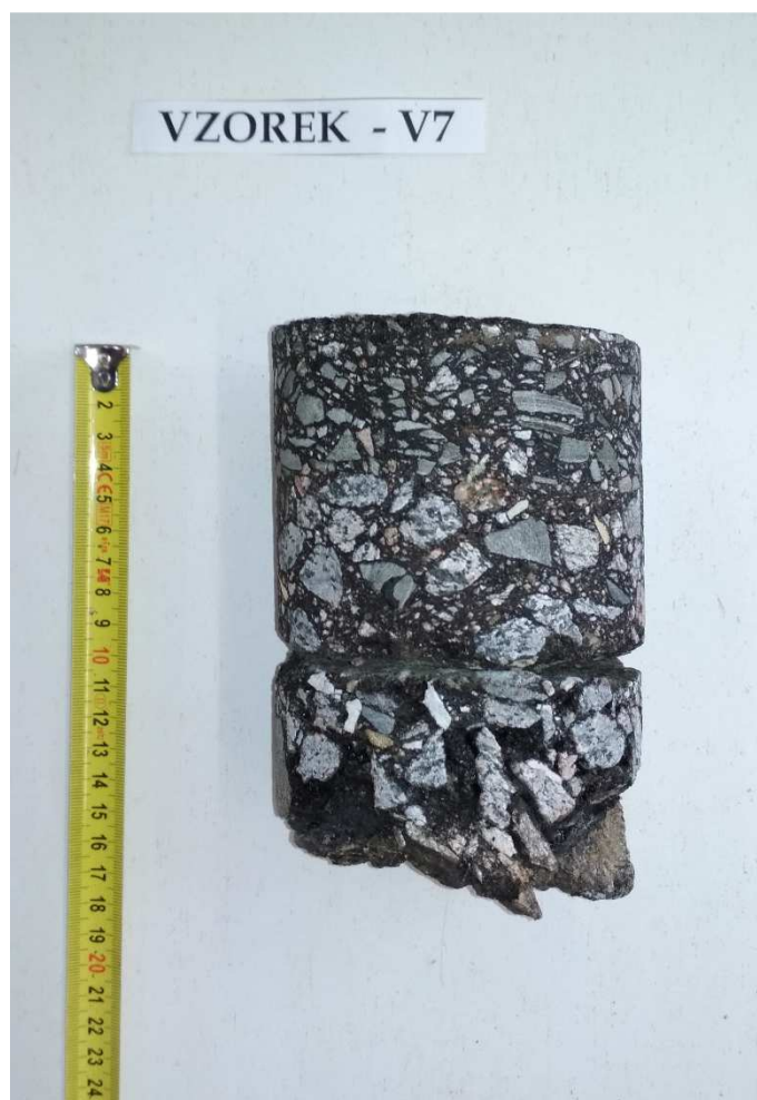
Obr. 14 - Jádro vývrtu Vzorek – V7 (laboratoř).
