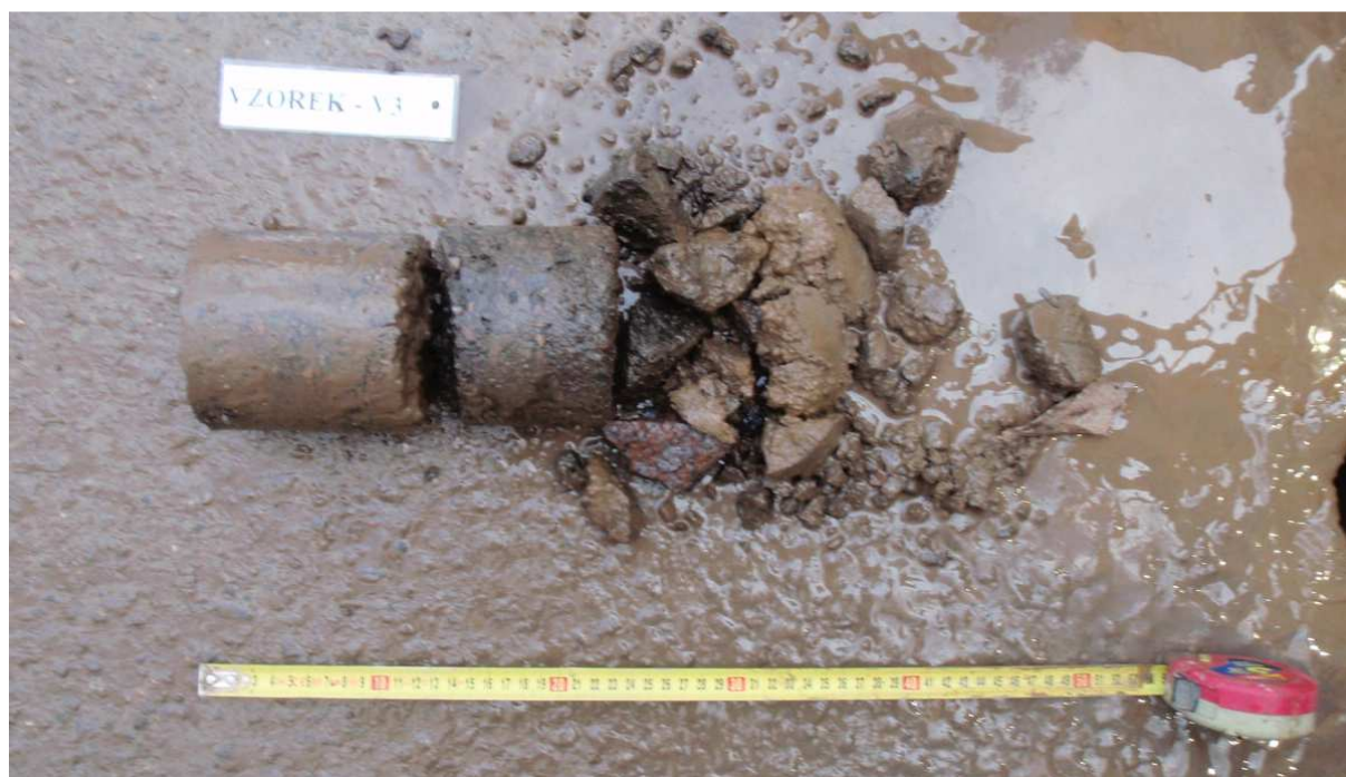
Obr. 5 - Jádro výtvetu Vzorek – V3 (in situ).
