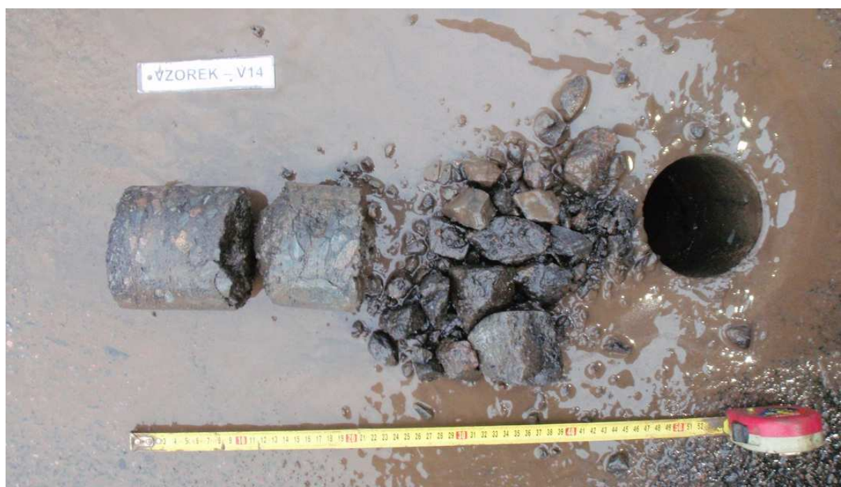
Obr. 27 - Jádru výtvetu Vzorek – V14 (in situ).
