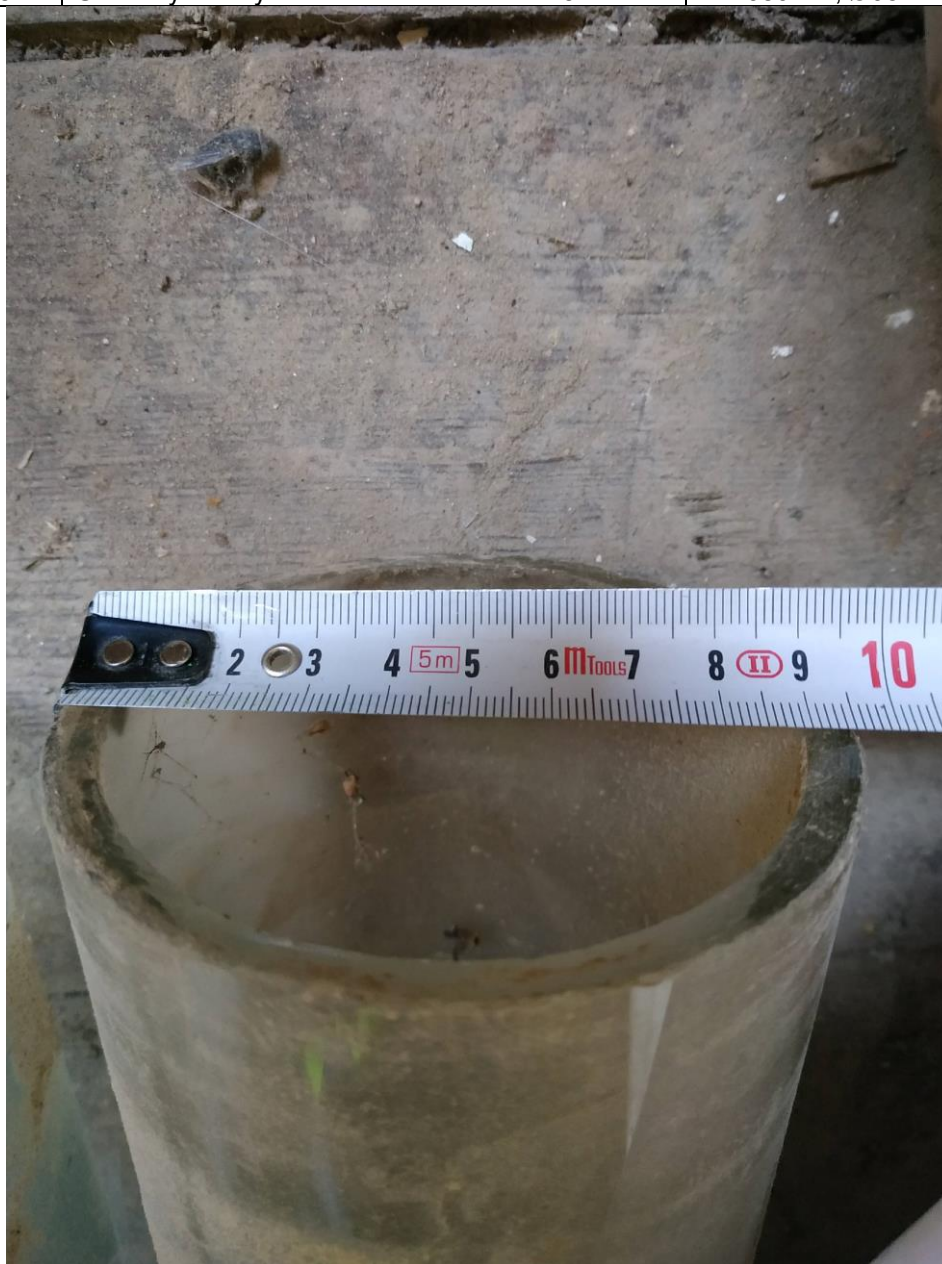
Detail průměru skleněných trubíc XM017.02.XX
