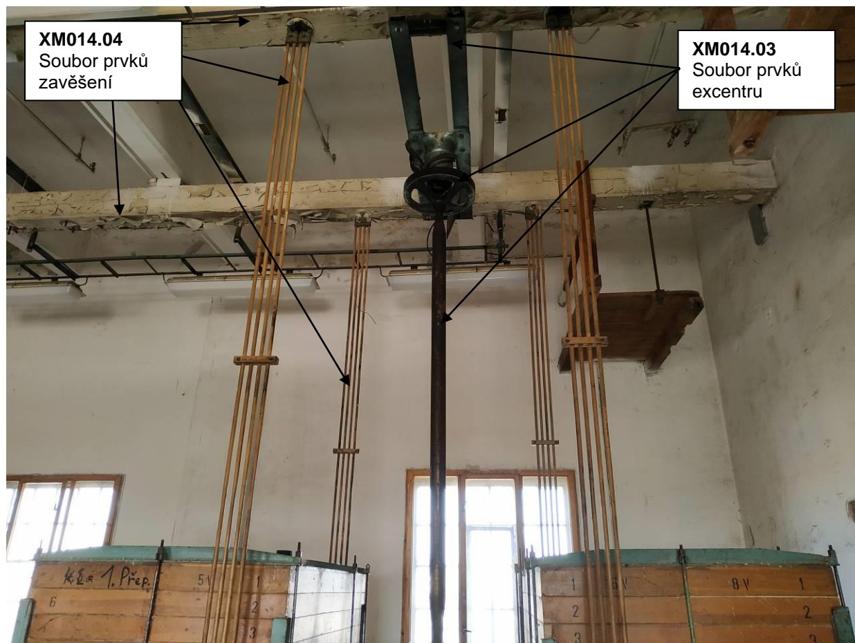
Pohled na bambusové závěsy (součást XM014.04) a pohon excentru (součást prvku XM014.03)
