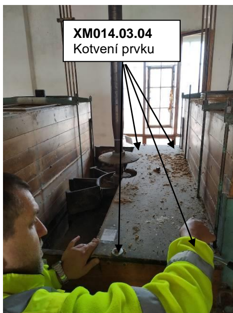
Demontáž horní krycí desky excentru XM014.03.04
