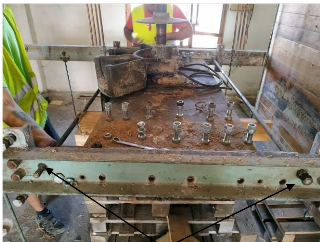
Vyznačení 2ks táhel XM014.03.10A a XM014.03.10B
