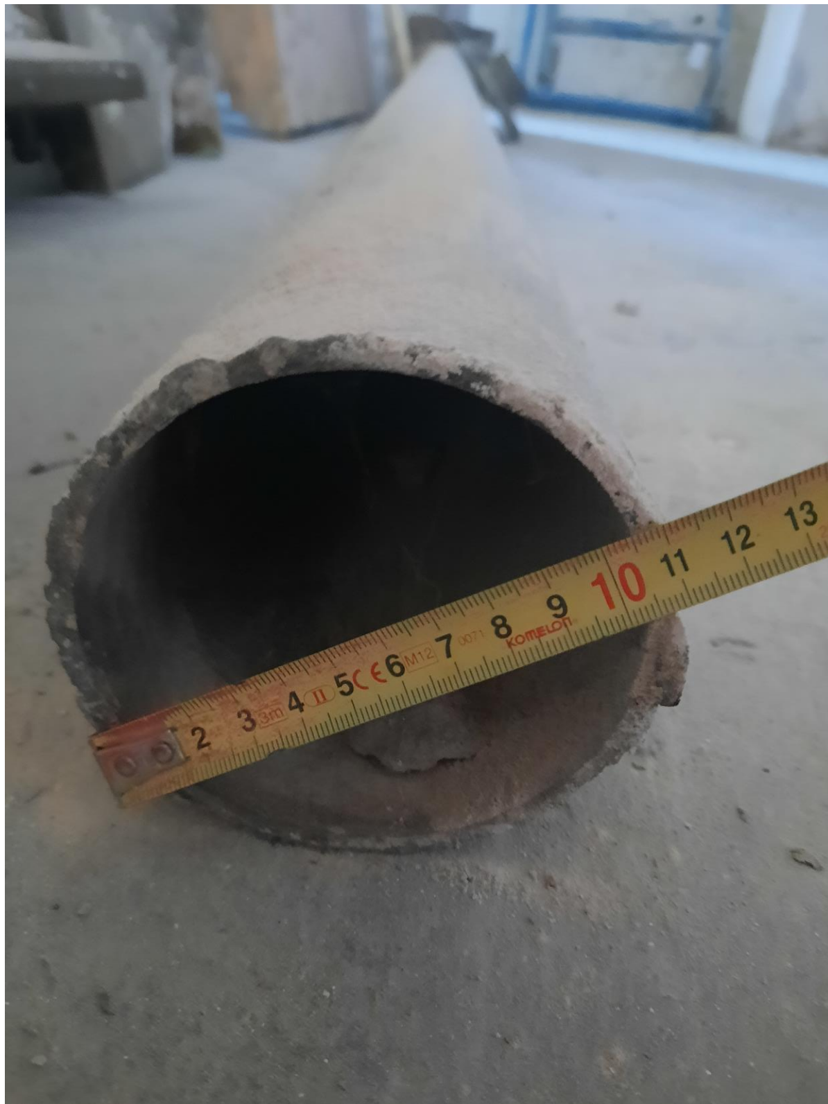
Vnější průměr ocelového prkvu XM007.02.05: 110mm
