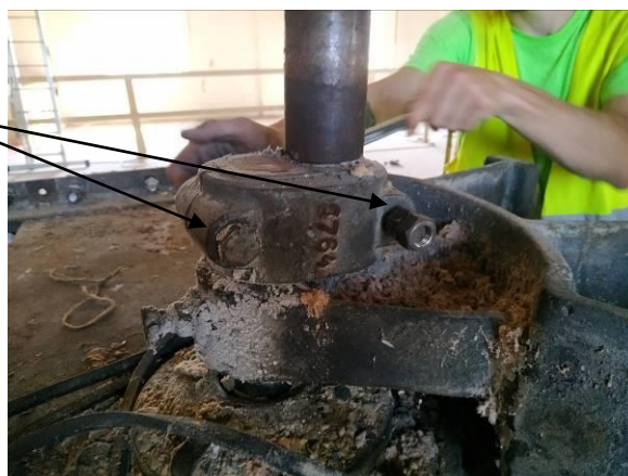
Pohled s vyznačením šroubů spojujících prvek XM014.03.06 – excentru s ocelovou deskou s prvek XM014.03.07 hřídel excentru.
