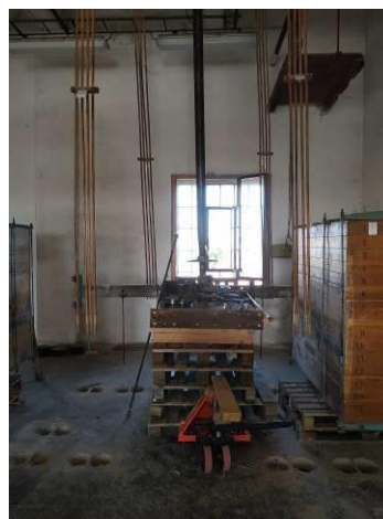
Podložení prvku XM014.03.06 paletami pro snazší transport a možnost sejmutí hřídele
