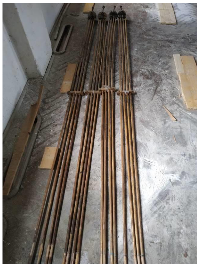
Demontovaná táhla XM014.04.01LČ, LZ, PČ, PZ. Šrouby ponechány v prvcích
