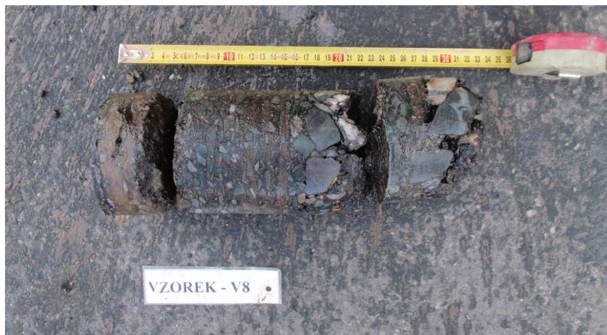
Obr. 15 - Jádru vývrtu Vzorek – V8 (in situ).
