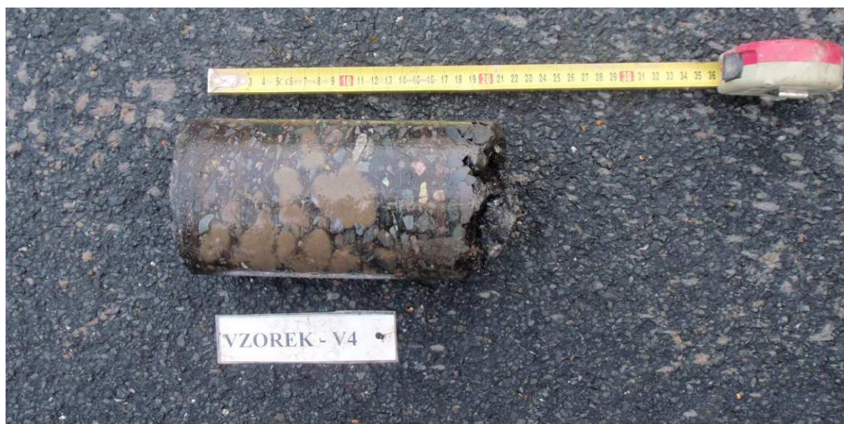
Obr. 7 - Jádro vývrtu Vzorek – V4 (in situ).
