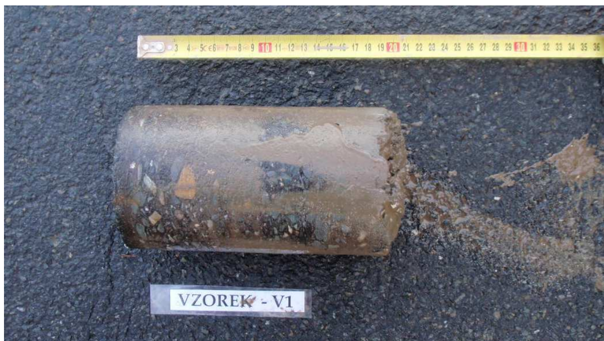
Obr. 1 - Jádro vývrtu Vzorek – V1 (in situ).
