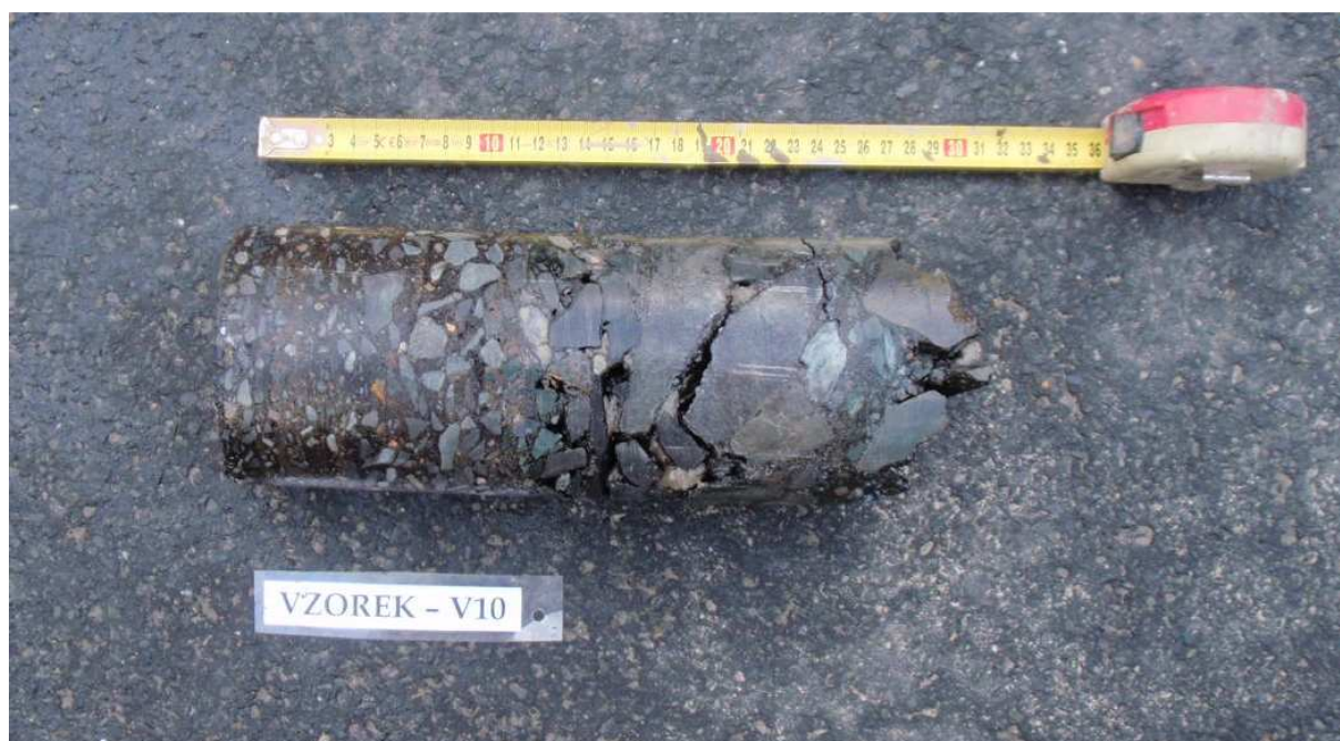
Obr. 19 - Jádro vývrtu Vzorek – V10 (in situ).
