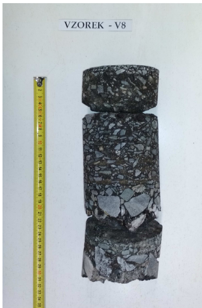
Obr. 16 - Jádru vývrtu Vzorek – V8 (laboratoř).
