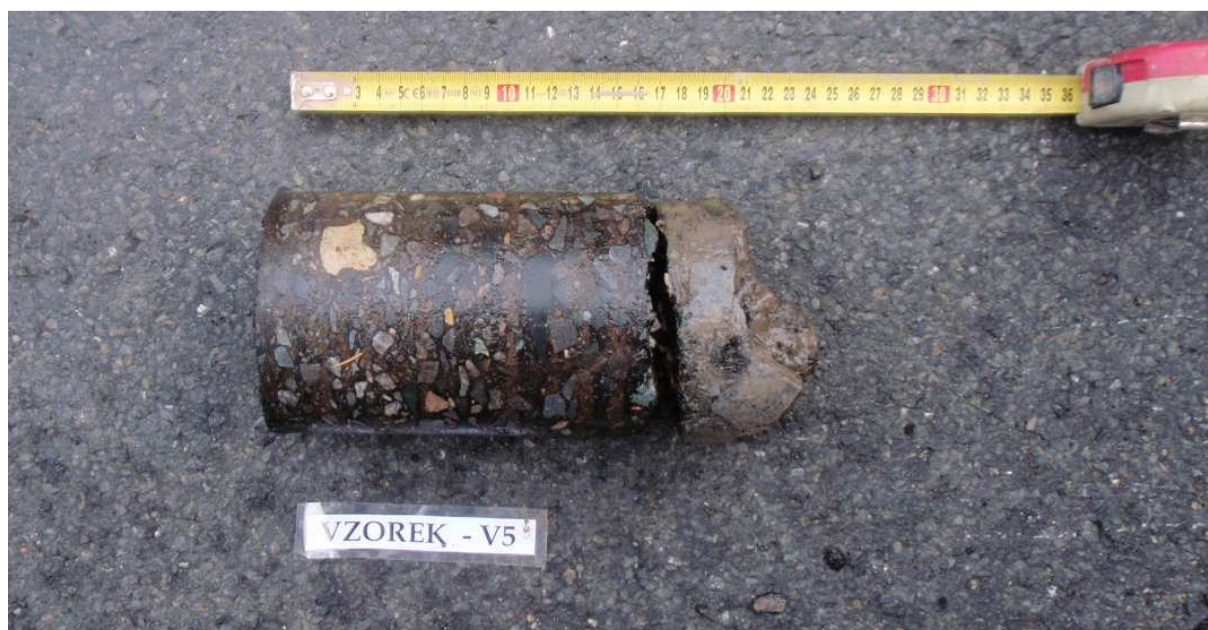
Obr. 9 - Jádro vývrtu Vzorek – V5 (in situ).
