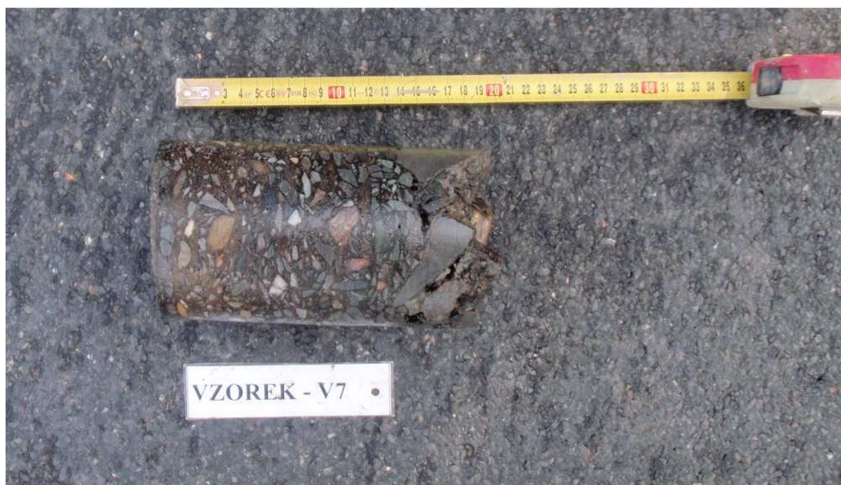
Obr. 13 - Jádro vývrtu Vzorek – V7 (in situ).
