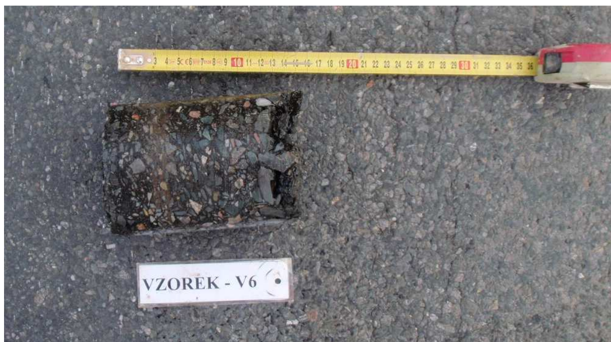
Obr. 11 - Jádro vývrtu Vzorek – V6 (in situ).
