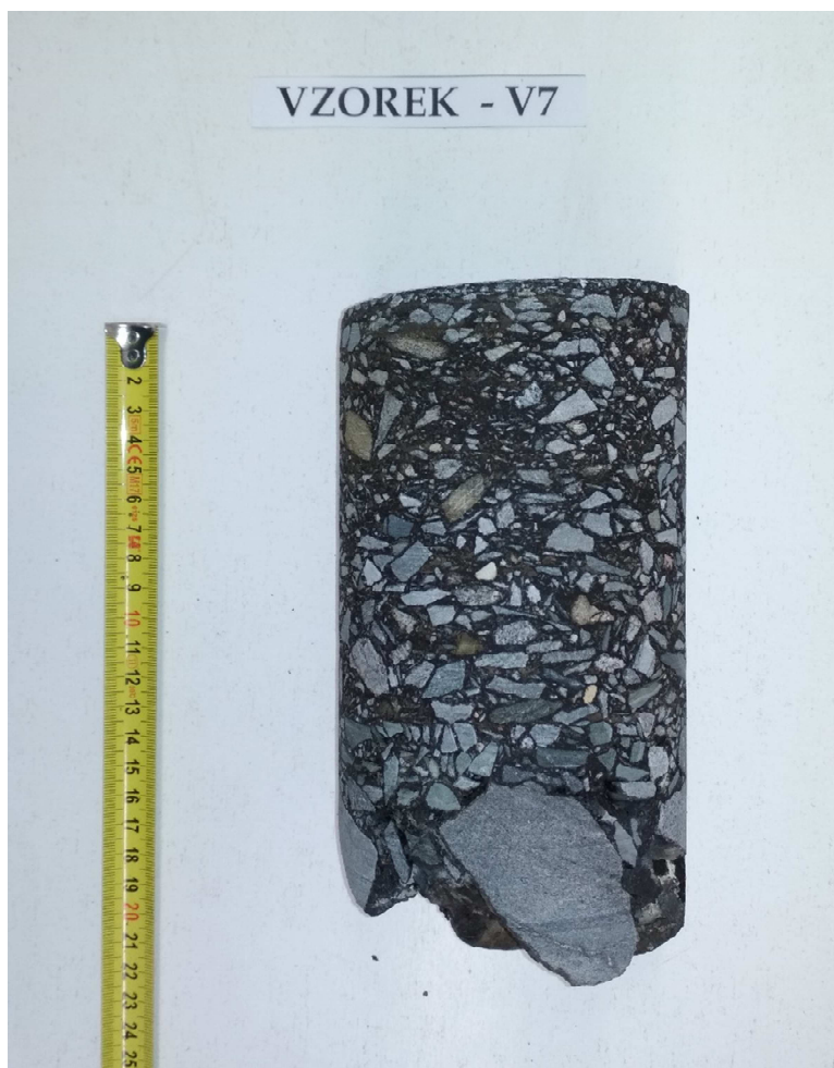
Obr. 14 - Jádro vývrtu Vzorek – V7 (laboratoř).
