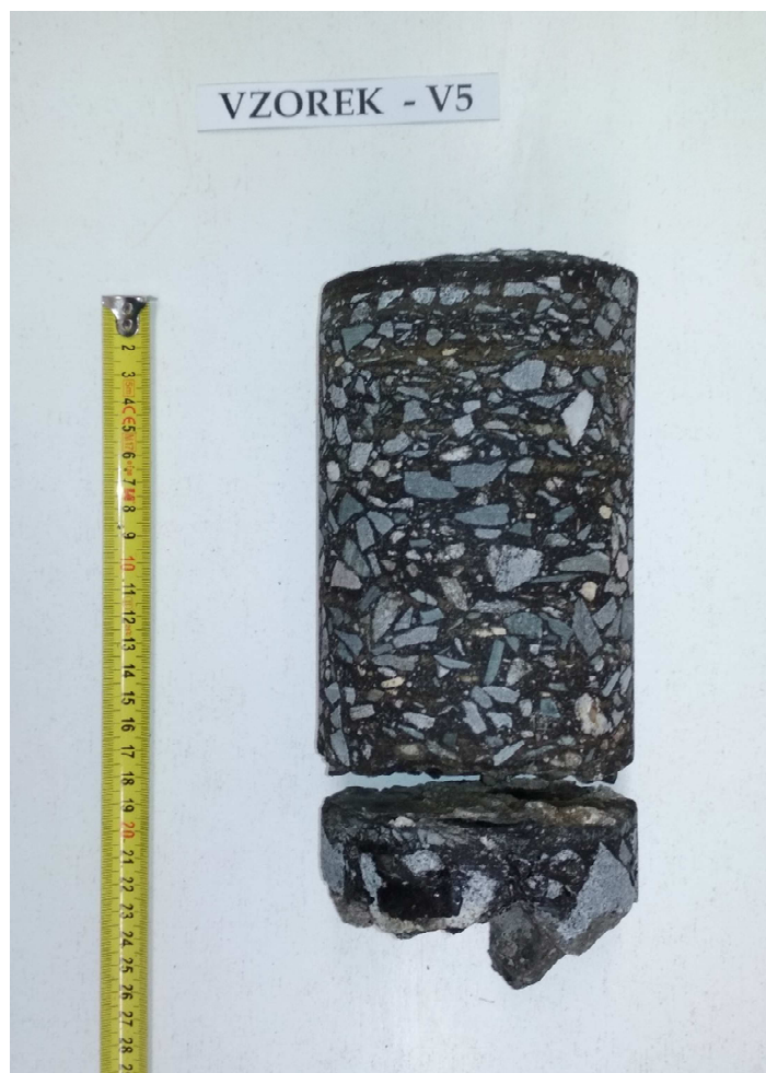
Obr. 10 - Jádro vývrtu Vzorek – V5 (laboratoř).
