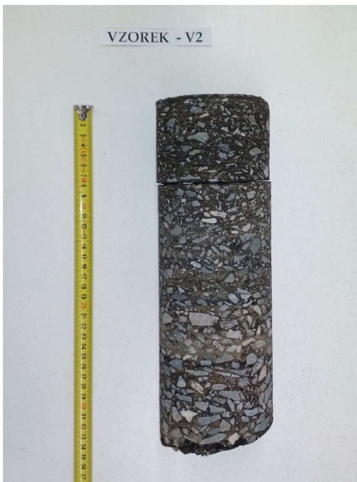
Obr. 4 - Jádru vývrtu Vzorek – V2 (laboratoř).
