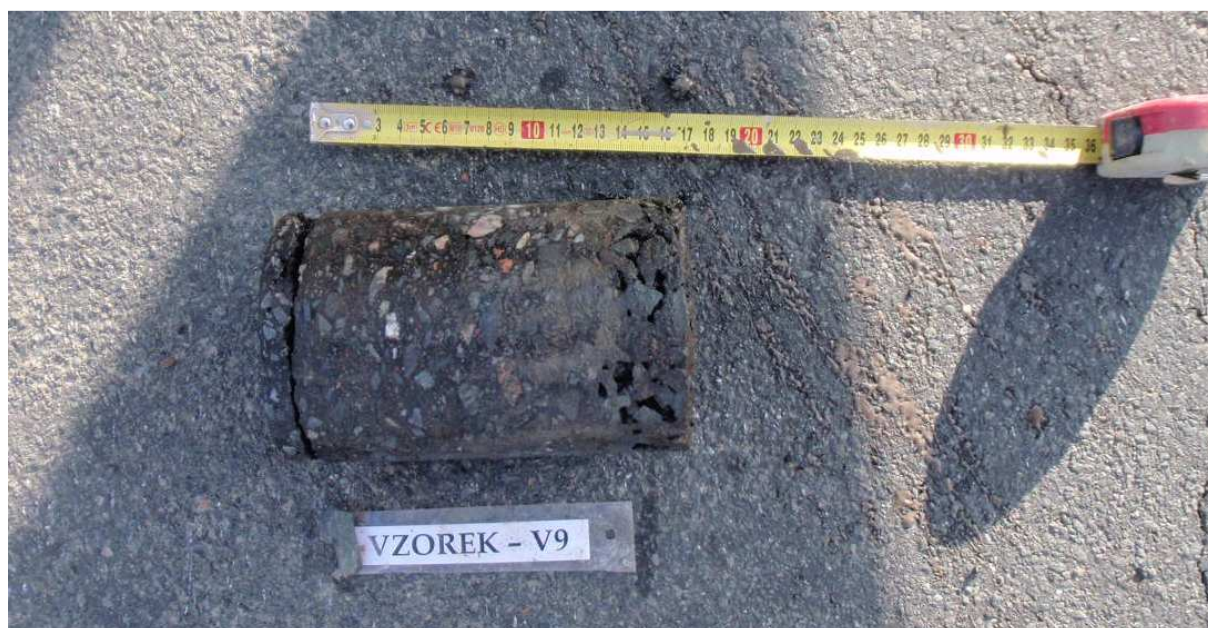
Obr. 17 - Jádro vývrtu Vzorek – V9 (in situ).
