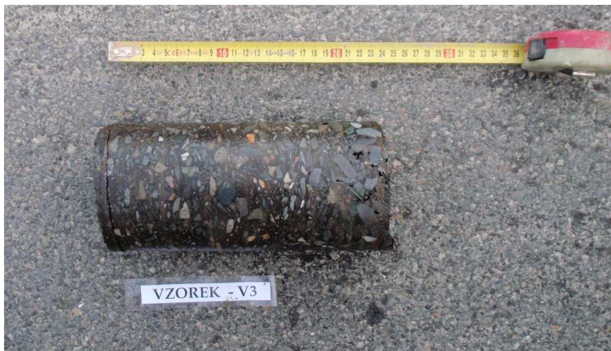
Obr. 5 - Jádro vývrtu Vzorek – V3 (in situ).
