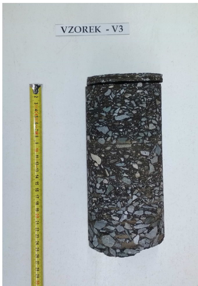
Obr. 6 - Jádru vývrtnu Vzorek – V3 (laboratoř).
