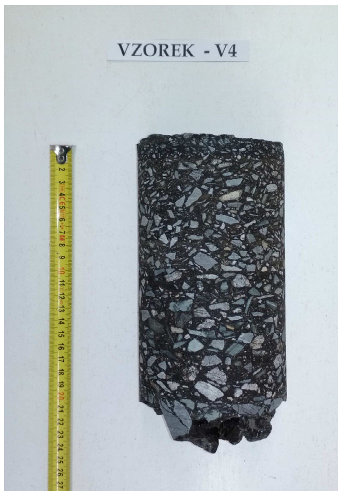
Obr. 8 - Jádru vývrtu Vzorek – V4 (laboratoř).
