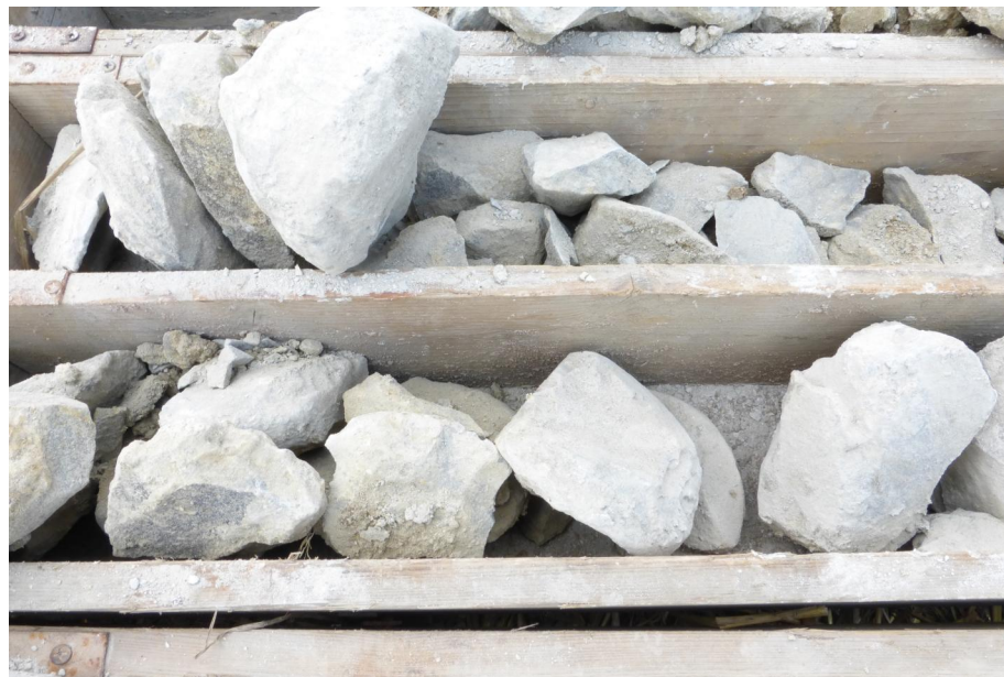
Foto č. 6: Výnos poloporušených vzorků zemin z průzkumné geologické sondy GS-3, detail.
