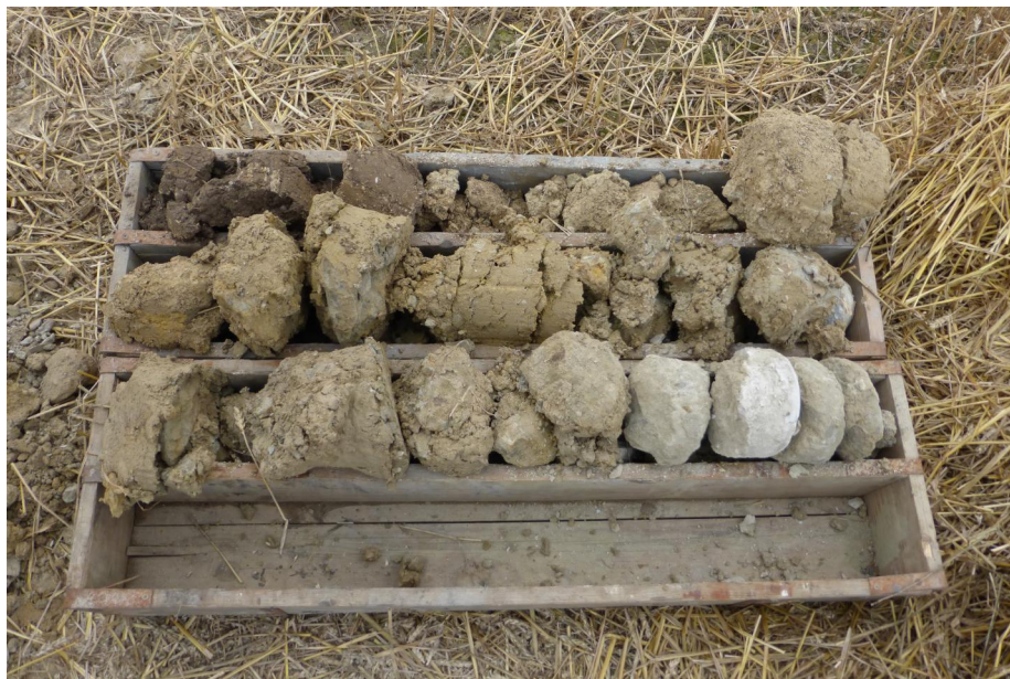
Foto č. 9: Výnos poloporušených vzorků zemin z průzkumné geologické sondy GS-6.
