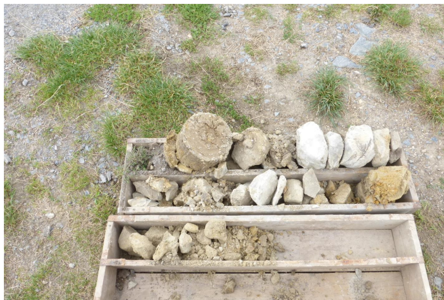
Foto č. 4: Výnos poloporušených vzorků zemin z průzkumné geologické sondy GS-2.
