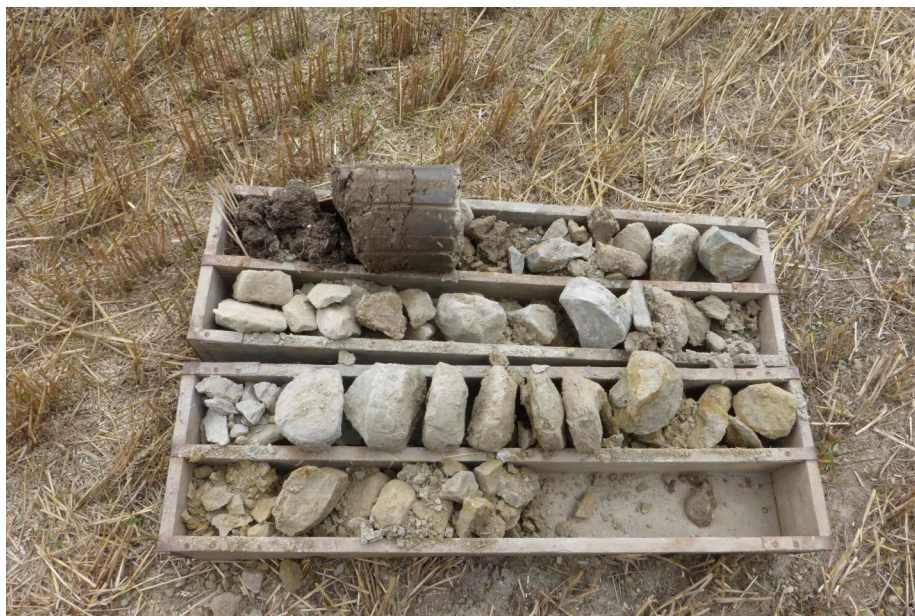
Foto č. 7: Výnos poloporušených vzorků zemin z průzkumné geologické sondy GS-4.
