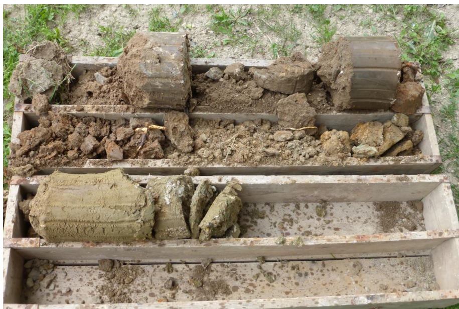
Foto č. 3: Výnos poloporušených vzorků zemin z průzkumné geologické sondy GS-1.
