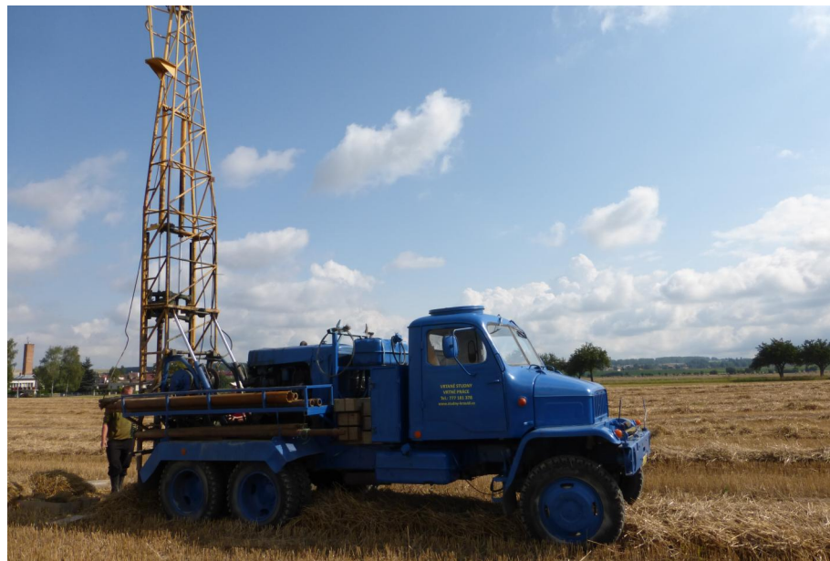
Foto č. 2: Vrtná souprava UGB-50 na podvozku automobilu V3S v době průzkumných vrtných prací.
