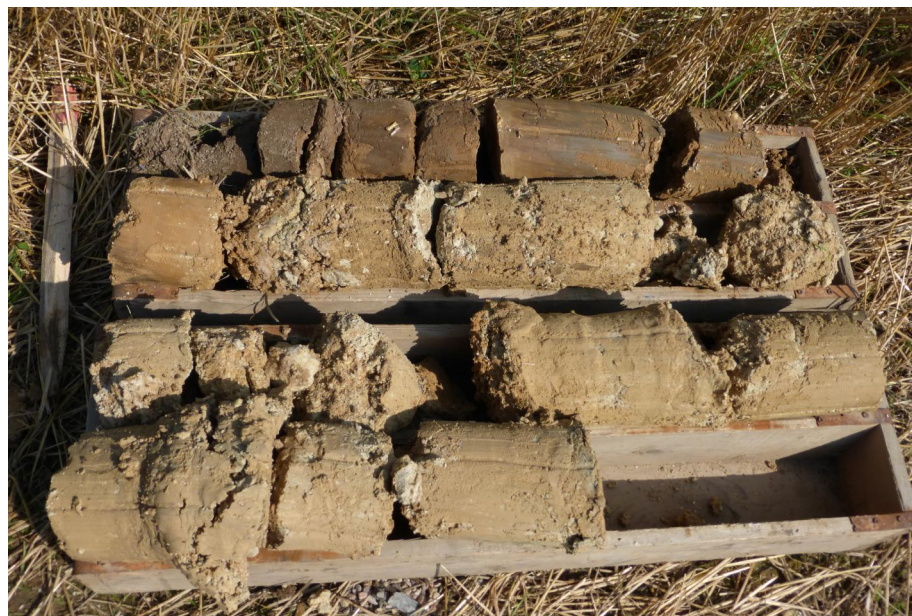
Foto č. 8: Výnos poloporušených vzorků zemin z průzkumné geologické sondy GS-5.
