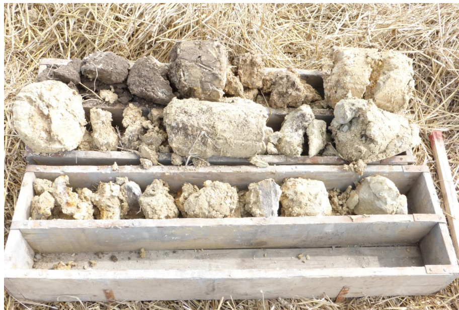
Foto č. 10: Výnos poloporušených vzorků zemin z průzkumné geologické sondy GS-7.
