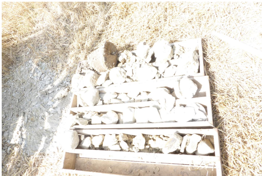
Foto č. 5: Výnos poloporušených vzorků zemin z průzkumné geologické sondy GS-3.
