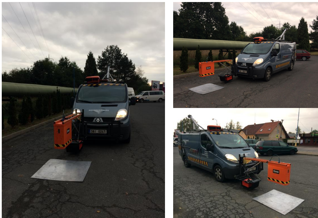
Obrázek 5. GPR měřicí systém společnosti Roadscanners CE vybavený 2 GHz “horn” anténou a 400 MHz ground-coupled anténou před vozidlem. Videokamera s GPS přijímačem (oranžový box) a laserový skener jsou upevněny na střeše vozidla, 3D akcelerometr na zadní nápravě vozidla.
