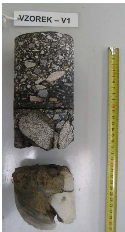
Obr.1 Vzorek – V1 (jádro vývrtu).
