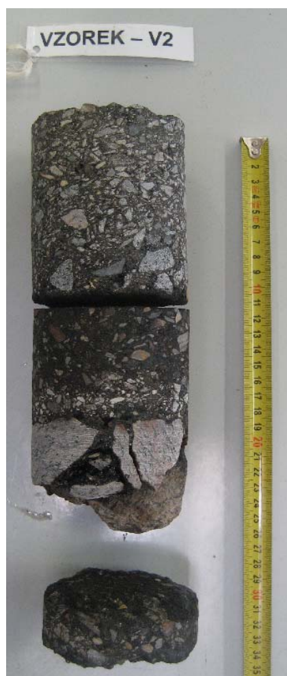
Obr.2 Vzorek – V2 (jádro vývrtu).
