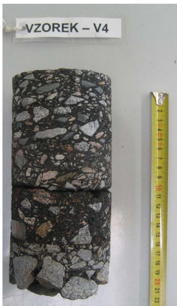
Obr.4 Vzorek – V4 (jádro vývrtu).
