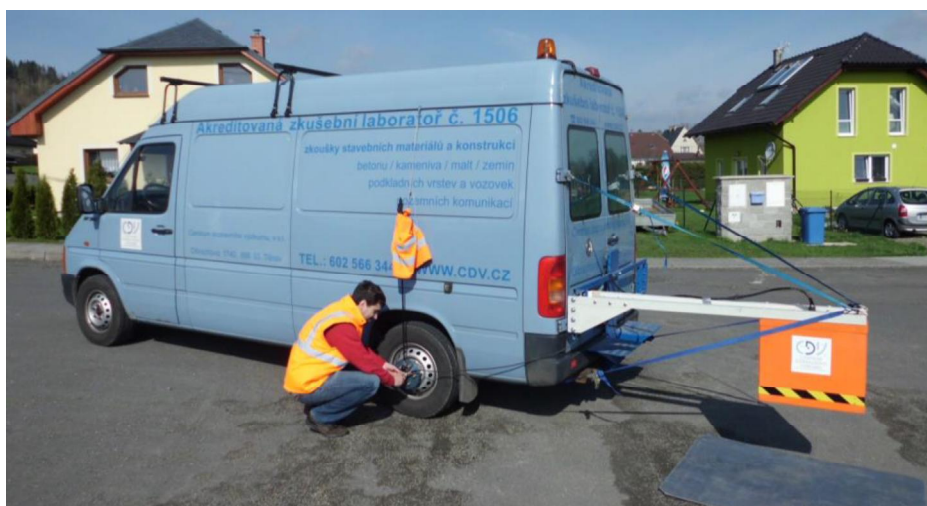
Obr. 3 Systém RoadScan pro měření při rychlostech za provozu – Horn antény 1,0 a 2,0 GHz umístěné za dodávku Volkswagen s polohovacím zařízením
